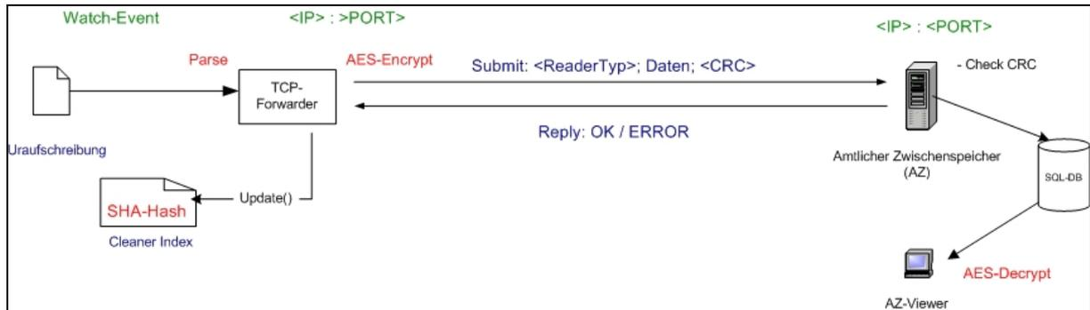
Abbildung 14: Datenübertragung durch den EPD-Forwarder
