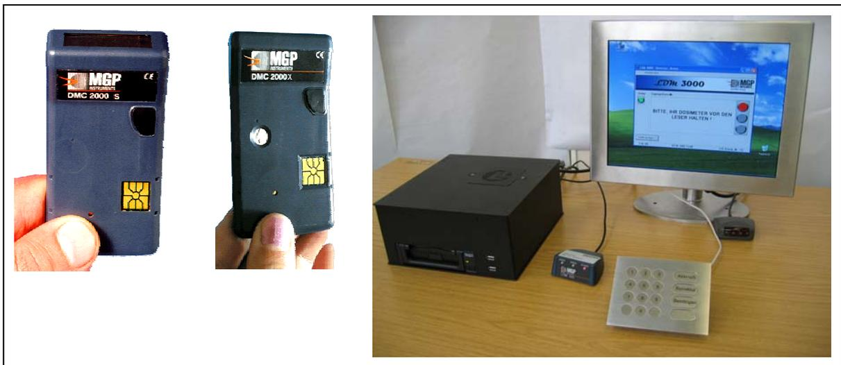
Abbildung 37: Dosimeter: DMC2000S und DMC2000X sowie Reader LDM3000 in Verbindung mit dem Lesekopf LDM220
