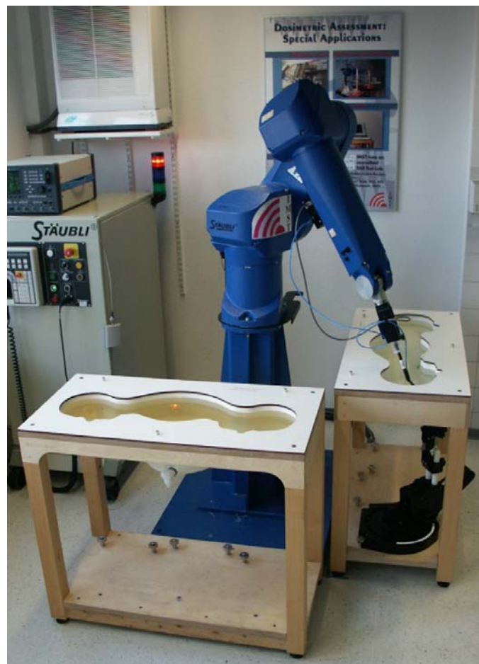
Bild 2.26 Messaufbau mit zwei Phantomen, die mit gewebesimulierender Flüssigkeit gefüllt sind
