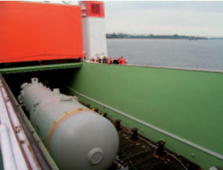
**Vier Dampferzeuger aus dem KKW Stade werden zum Transport nach Schweden auf ein Schiff verladen**
