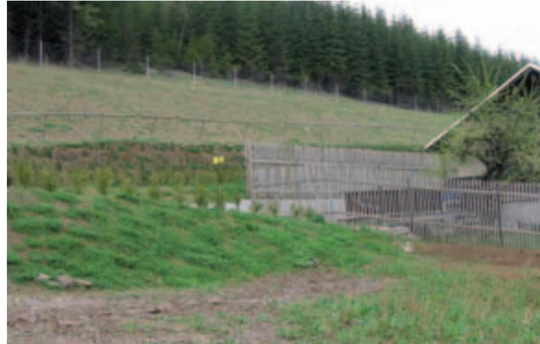
**Messpunkt des BfS zur Ermittlung der Langzeit-Radonkonzentration im Freien mit jeweils zwei in 1,5 m Höhe halbjährlich exponierten Kernspurdetektoren**
