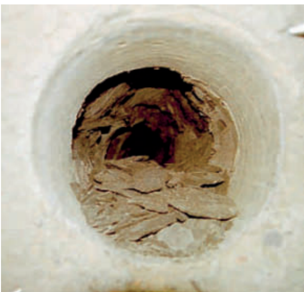
Übertragung des Schädigungs- und Deformationsverhaltens in Bohrungen auf das gebirgsmechanische Verhalten von Strecken
