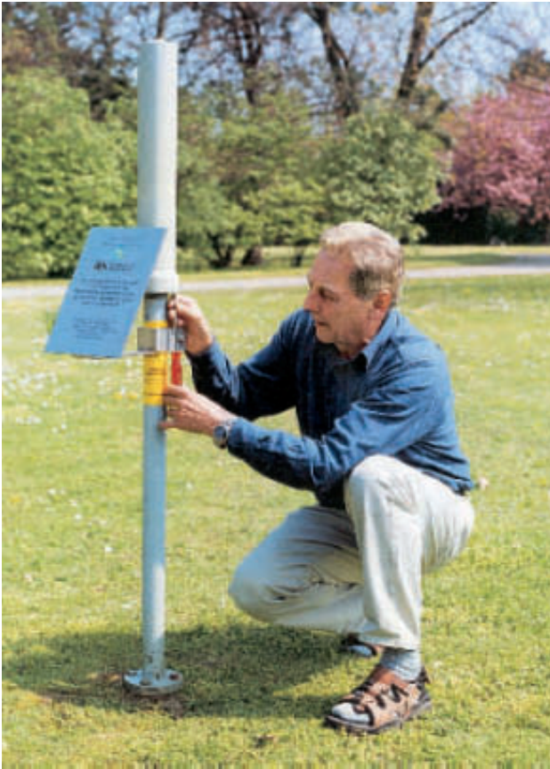
Mitarbeiter des BfS beim Auswechseln einer der über 2.000 Messsonden des IMIS
