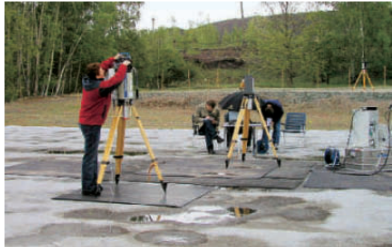
Drei Messteams installieren ihre In-situ-Gammaspektrometer auf einer Kalibrierfläche der Wismut GmbH
