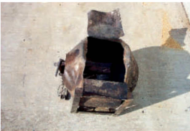
Metalltrommel und darin enthaltene Neutronenquellen (18,5 und 703 GBq Am-241/Be)
