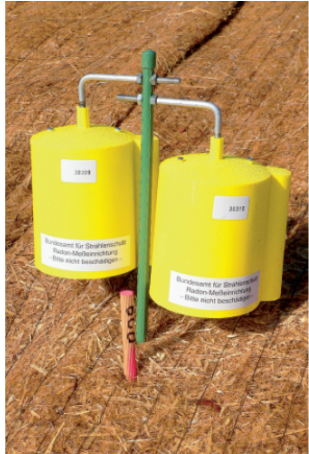
Messeinrichtung zur Ermittlung der Radonkonzentration in 0,15 m Höhe über der Oberfläche einer Halde des ehemaligen Uranbergbaus
