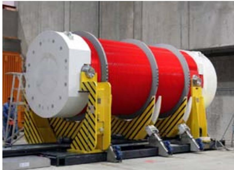
**Transport- und Lagerbehälter CASTOR HAW28M während der Kalthandhabung im Transportbehälterlager Gorleben (Quelle: GNS)**
