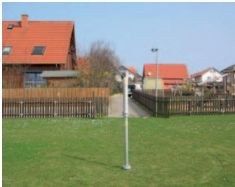
**Messsonde des BfS zur Überwachung der Gamma-Ortsdosisleistung (ODL) in der Gemeinde Kissenbrück**
