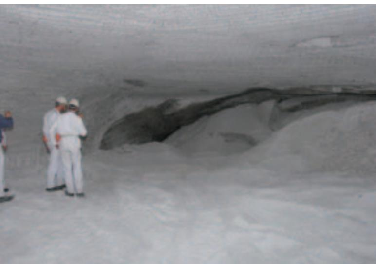
**Kammer 7/725 nach Beseitigung der Gefahrensituation (Entfernen der Abschalung und Abdeckung der Abfälle)**
