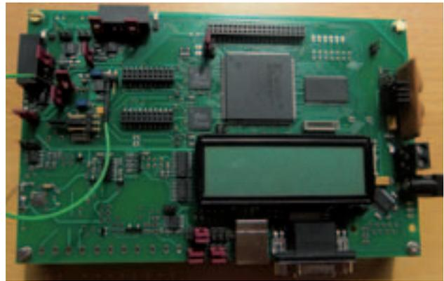
Abbildung des in Kooperation mit der Universität Freiburg entwickelten digitalen Vielkanalanalysators
