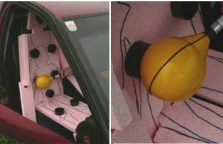
Messung mit Magnetfeldsonde an definierten Messpunkten am Beifahrerplatz eines Fahrzeugs mit Elektro-Hybridantrieb
