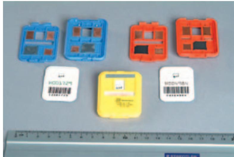
**Film dosimeter zur Messung von externer Strahlung bei strahlen-schutzüberwachten Beschäftigten der Asse**
