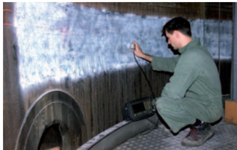
Manuelle Ultraschallprüfung am Großbehälter der MPA Stuttgart. Der Großbehälter ist ein unbestrahlter Reaktordruckbehälter, an dem die MPA Prüfungen durchführen kann. (Quelle: MPA Stuttgart)
