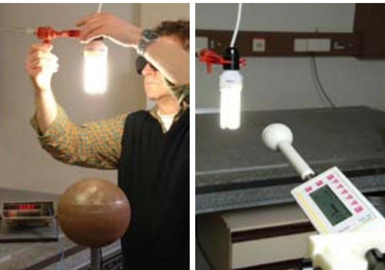
**Messung elektrischer und magnetischer Felder an einer Kompaktleuchtstofflampe**
