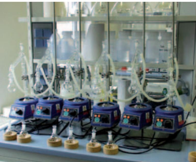
Apparatur zur Destillation von Wasserproben für die H-3-Bestimmung
