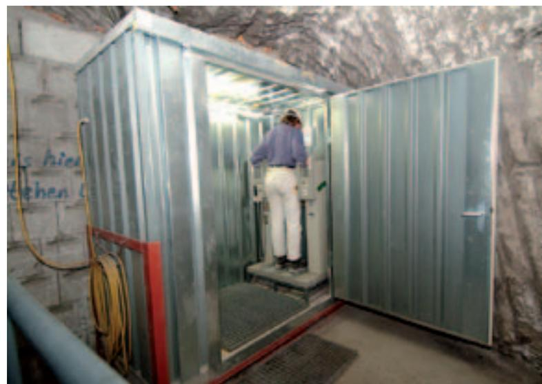
Kontaminationsmonitor zur Überprüfung der Personen auf Kontamination
