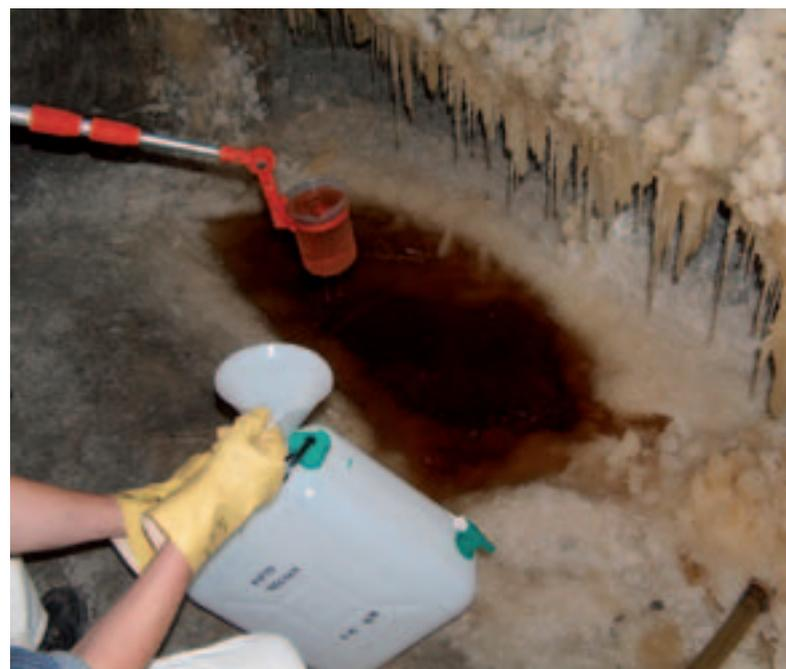
Entnahme einer Probe an der Messstelle MP\_37 in der Schachanlage Asse II
