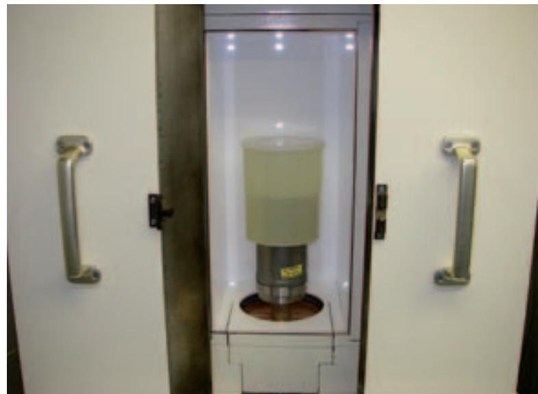
Gamma-spektrometrische Messanordnung zur Bestimmung der Aktivitätskonzentrationen von Radionukliden in Salzlösungen der Schachtanlage Asse II
