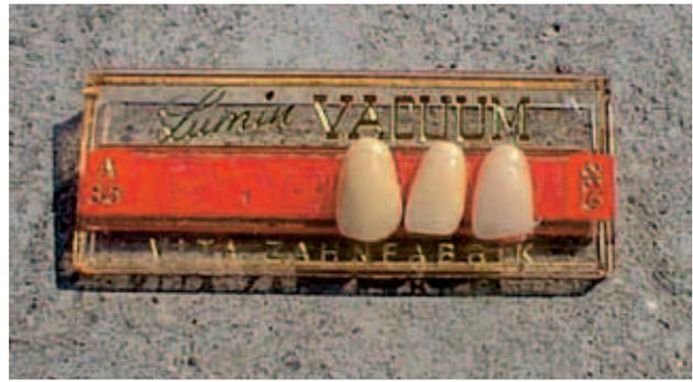
Verschiedene Materialien, hier Schneidezähne aus Porzellan, wurden überprüft, ob sie zur retrospektiven Ermittlung der Dosen in einer Unfallsituation geeignet sind.
