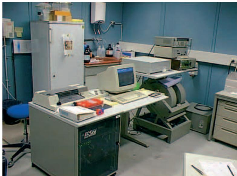
Labor zur Ermittlung der absorbierten Dosis von Milchzähnen mittels EPR-Dosimetrie
