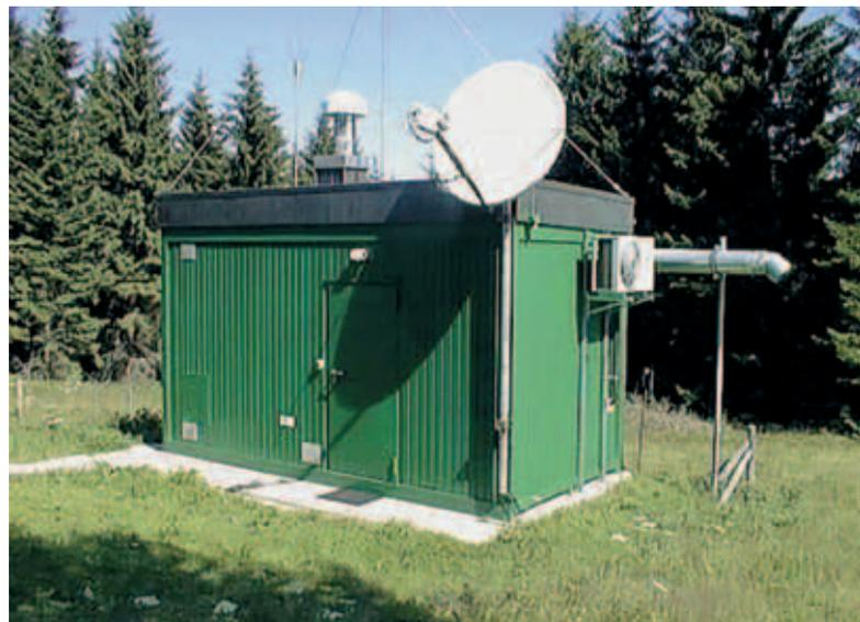
Messcontainer auf dem Schauinsland für die Überwachung des Kernwaffenteststoppsabkommens mit Satellitenantenne zur Datenübertragung an das Internationale Datenzentrum in Wien
