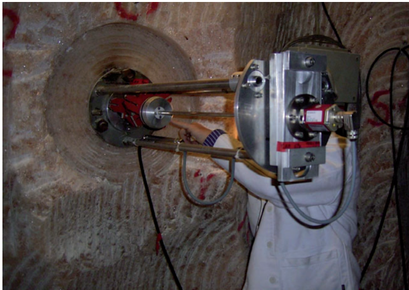
Abb. 4: Extensometer im Endlager Asse II mit Sensor für die Online-Registrierung.
