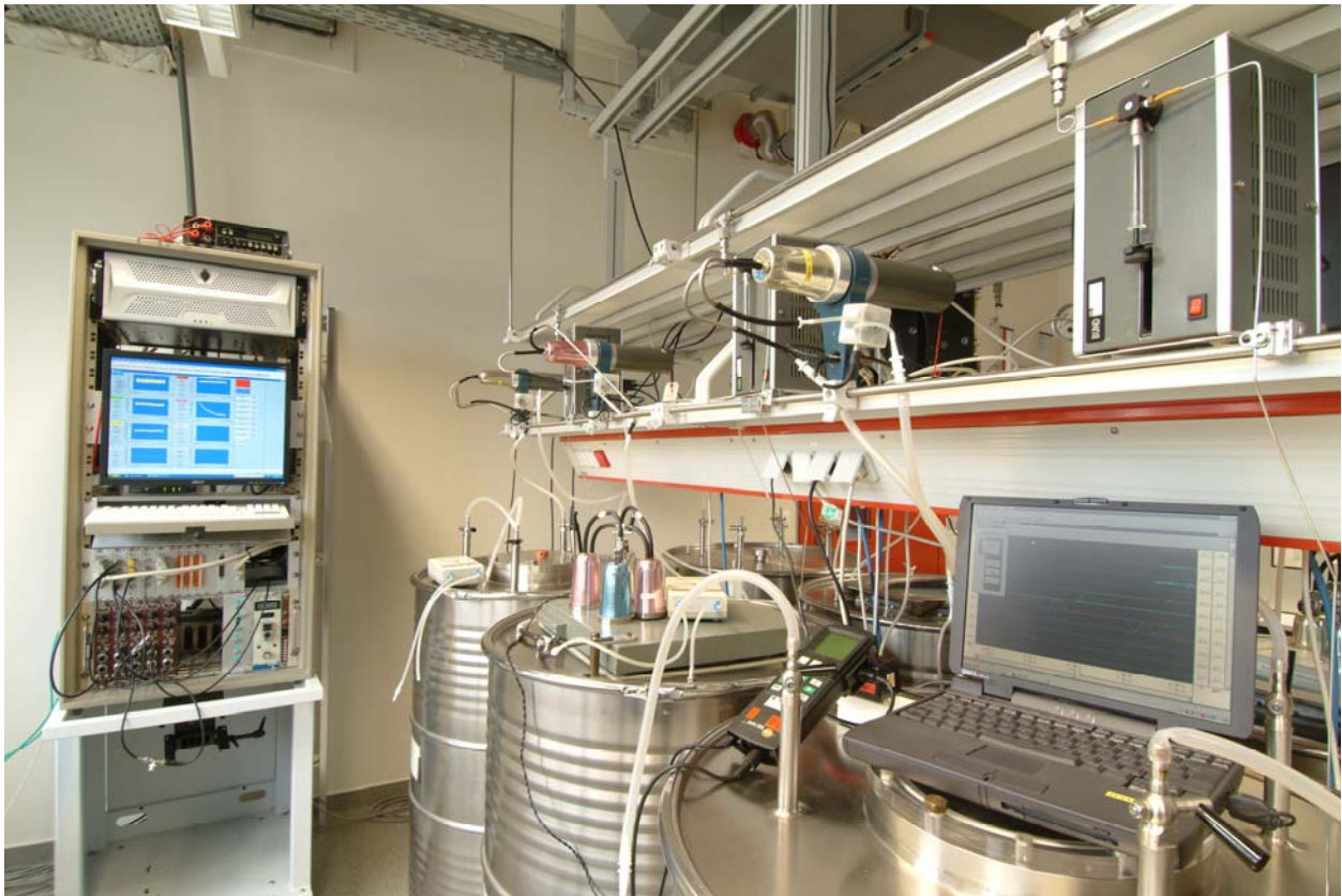
Abbildung 1: Kalibrierlabor für Radonmessgeräte des Bundesamtes für Strahlenschutz mit Kalibrierbehältern (Volumen: 0,4 m 3 ) Figure 1: Radon Calibration Laboratory of the Federal Office for Radiation Protection with calibration containers (volume: 0.4 m 3 )
