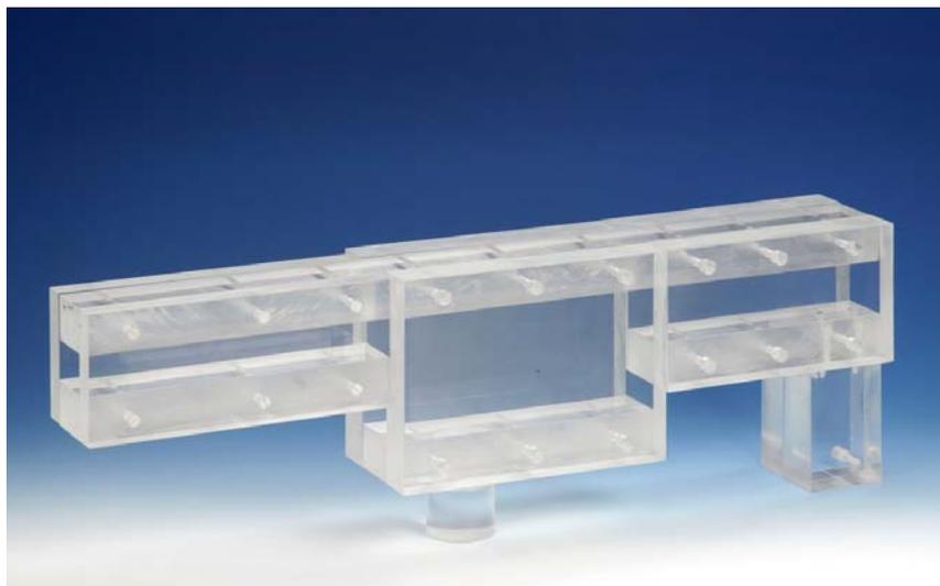
**Abbildung 8: Hunde-Phantom "Kira", gefertigt aus PMMA.**
