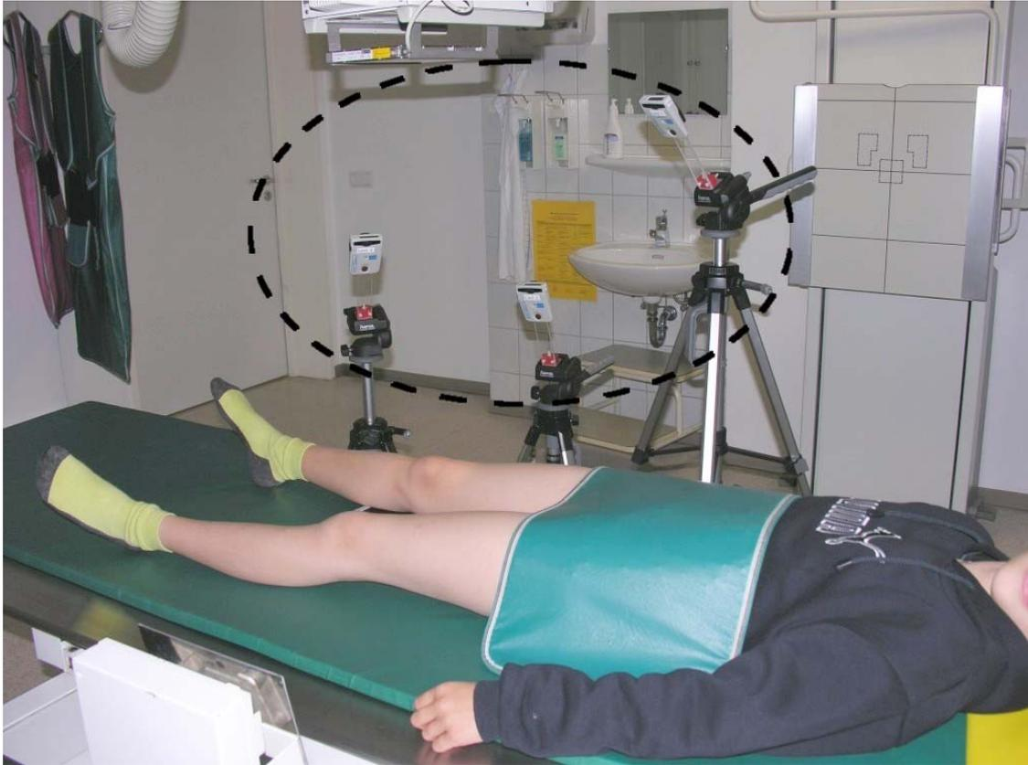
**Abbildung 12: Röntgenuntersuchung eines Knies. Die Dosis aufgrund von Streustrahlung wurde mit den auf Photo-Stativen befestigten Dosimetern des Typs EPD Mk2 gemessen.**
