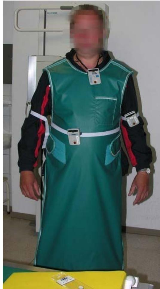
**Abbildung 6: Die EPD Mk2 wurden mittels Klettbandern an den helfenden Personen befestigt.**
