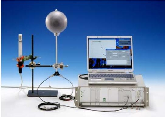
**Abbildung 1:**  $H^*(10)$ -Sekundärnormalionisationskammer (HS01, Mitte) mit der speziellen Messelektronik, bestehend aus dem Temperatur- und Feuchte-Sensor (links) sowie den Elektronik-Einschüben und dem Laptop (rechts).
