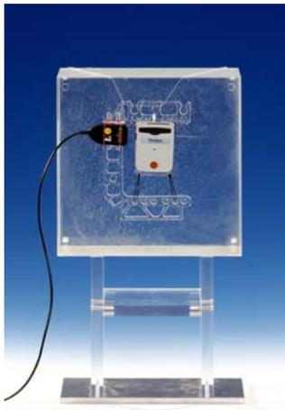
**Abbildung 3:** Elektronisches Personendosimeter EPD Mk2 von Thermo Electron (Erlangen) auf einem Quader-PMMA-Phantom.
