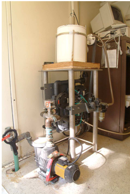
Abbildung 26: Wasserprobenahmegerät zur Probenahme aus dem Salzbach
