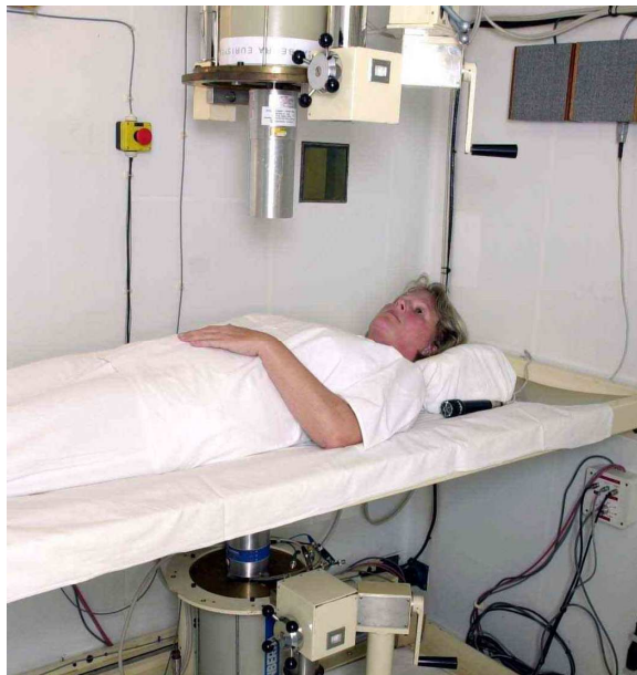
Abbildung 13: Messung im Ganzkörperzähler im Labor des BfS in Berlin
