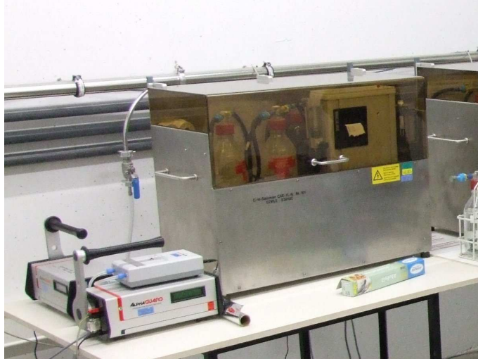
Abbildung 18: Sammeleinrichtung zur Bestimmung des Radionuklids Kohlenstoff-14
