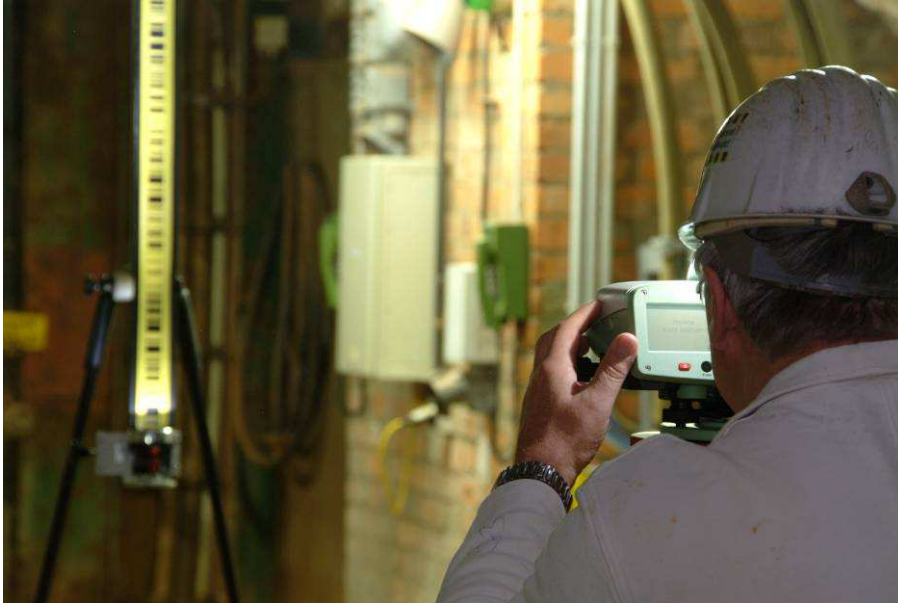
Abbildung 5: Messung der Firstsenkungsraten
