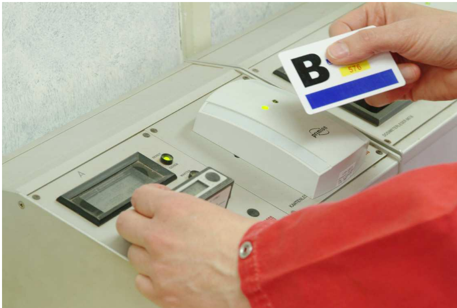
Abbildung 10: Auslesen betrieblicher Dosimeter im Kontrollbereich des Endlagers Morsleben
