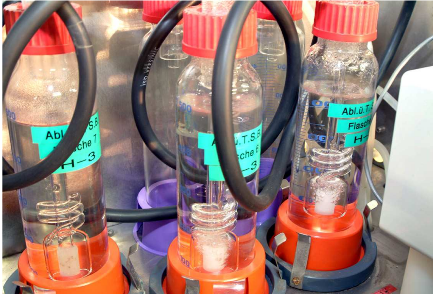
Abbildung 16: Waschflaschen des Tritium (H-3)-Probenahmeverfahrens
