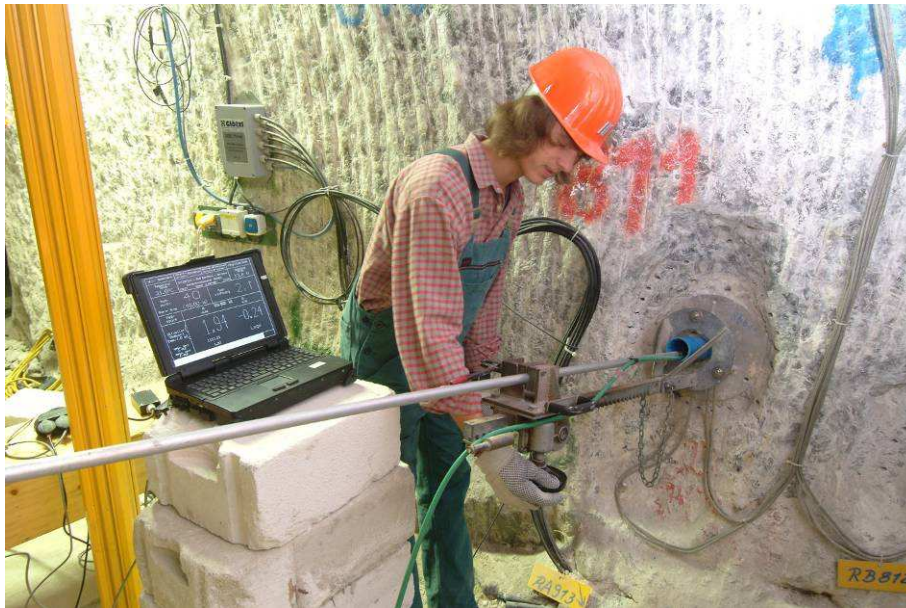
Abbildung 6: Durchführung einer Lageänderungsmessung
