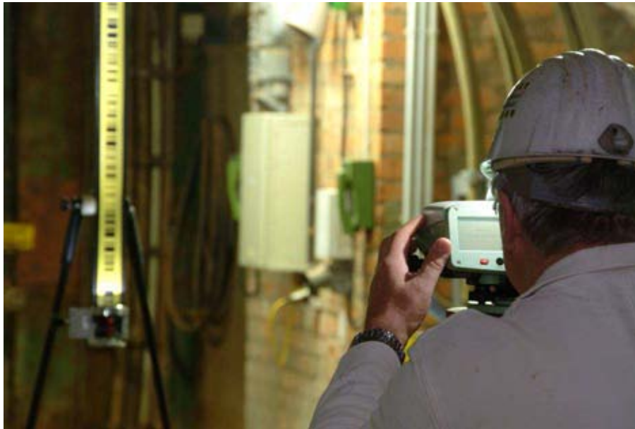
Abbildung 5: Messung der Firstsenkungsraten
