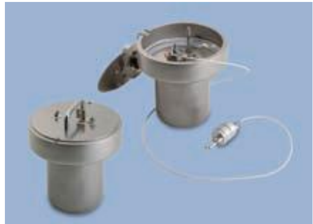
Abbildung 4.3-2: Wechselcontainer zur Be- und Entladung von Afterloading-Tanks (Nucletron B.V., Niederlande).
