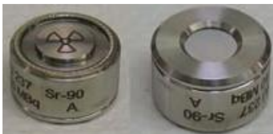
Abbildung 4.1-3: Sr-90-Strahlenquelle, Rückseite (links) und Vorderseite (rechts) mit Strahlenfenster (Eckert & Ziegler Nuclitec GmbH)
