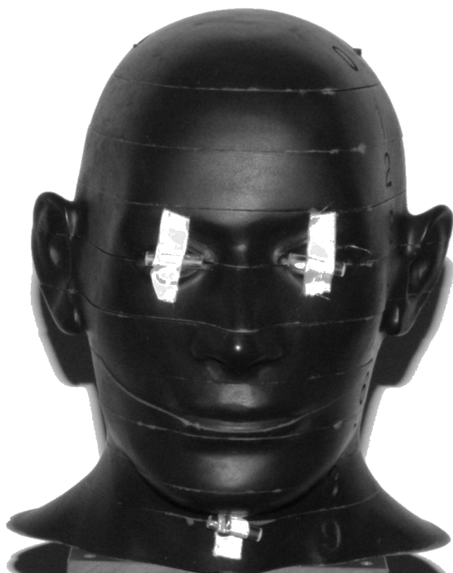
Abb. 3-9 Bestücktes Kopfphantom en face. Zu sehen sind die auf der Oberfläche angebrachten TLDs im Bereich der Augenlinsen und der Schilddrüse.
