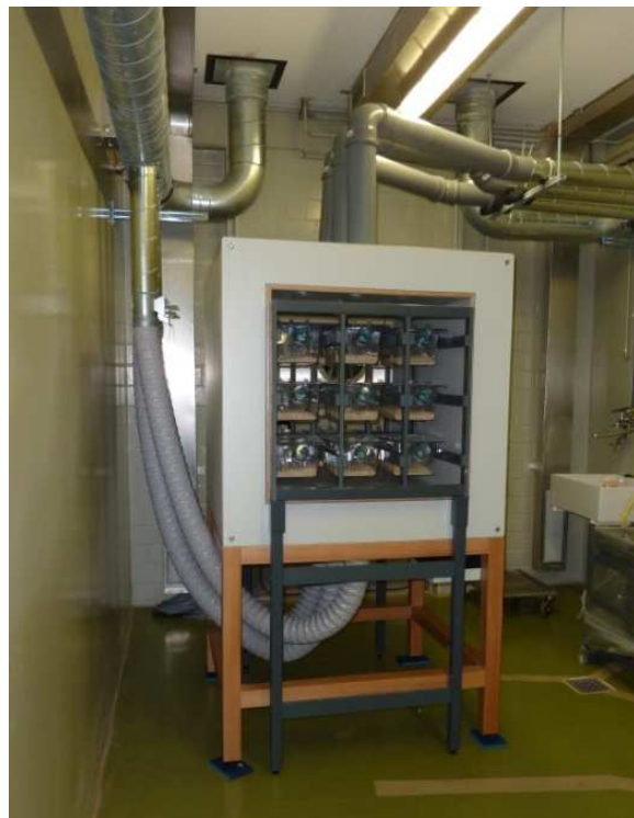
Bild 3: Realisierung eines Spulensystems mit Tierkäfigen, Halterung für die Käfige und Schläuchen für die Luftzirkulation.
