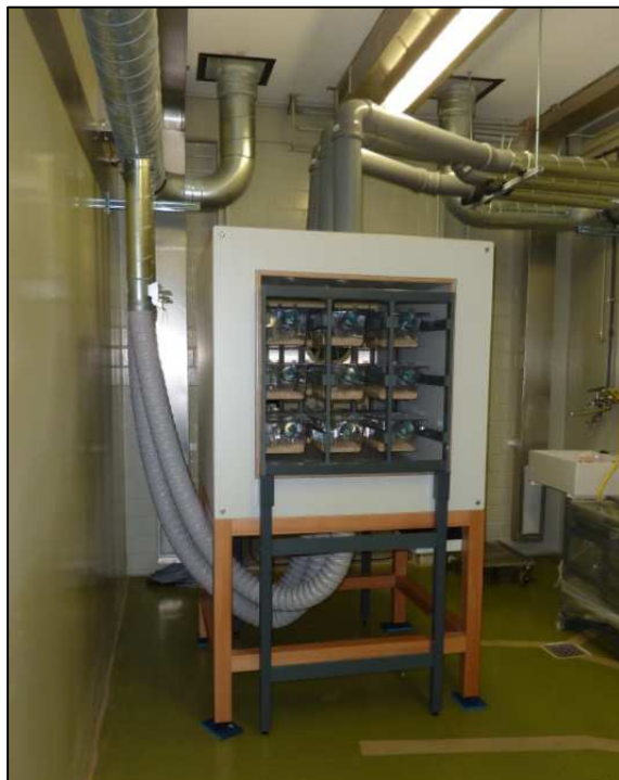
Abb. 3: Realisierung eines Spulensystems mit Tierkäfigen, Halterung für die Käfige und Schläuchen für die Luftzirkulation.
