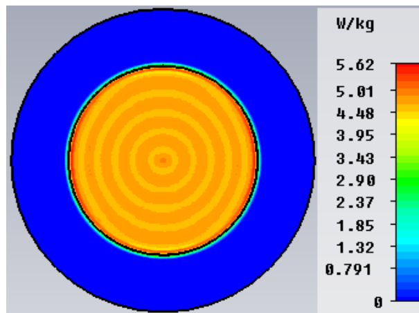
Abbildung 34: SAR-Verteilung 20 µm über dem Schalenboden bei Anregung mittels ebener Welle der Feldstärke 61,4 V/m und Mittelung über 0,001 g
