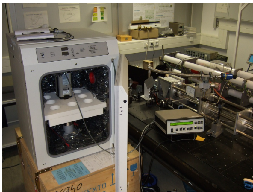
Abbildung 27: Kontrolle der Inkubatorposition mit dem Polytec Rk-5700
