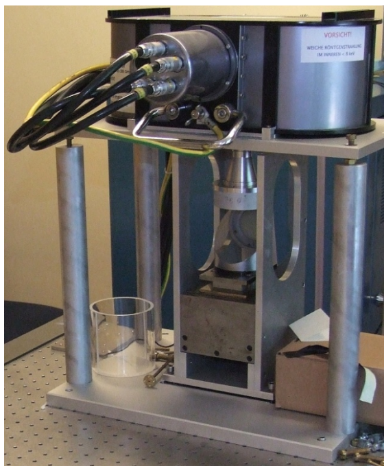
Abbildung 6: Oben: Frequenzvervielfacherkaskade mit Parabolspiegel (links) für die Expositionen bei 106 GHz und mit Netzteil und Signalgenerator als Speisequelle (rechts) - unten: Rückwärtswellenoszillator (Carcinotron) mit strahlformender Linsenoptik und planarem Umlenkspiegel für die Expositionen bei 380 GHz
