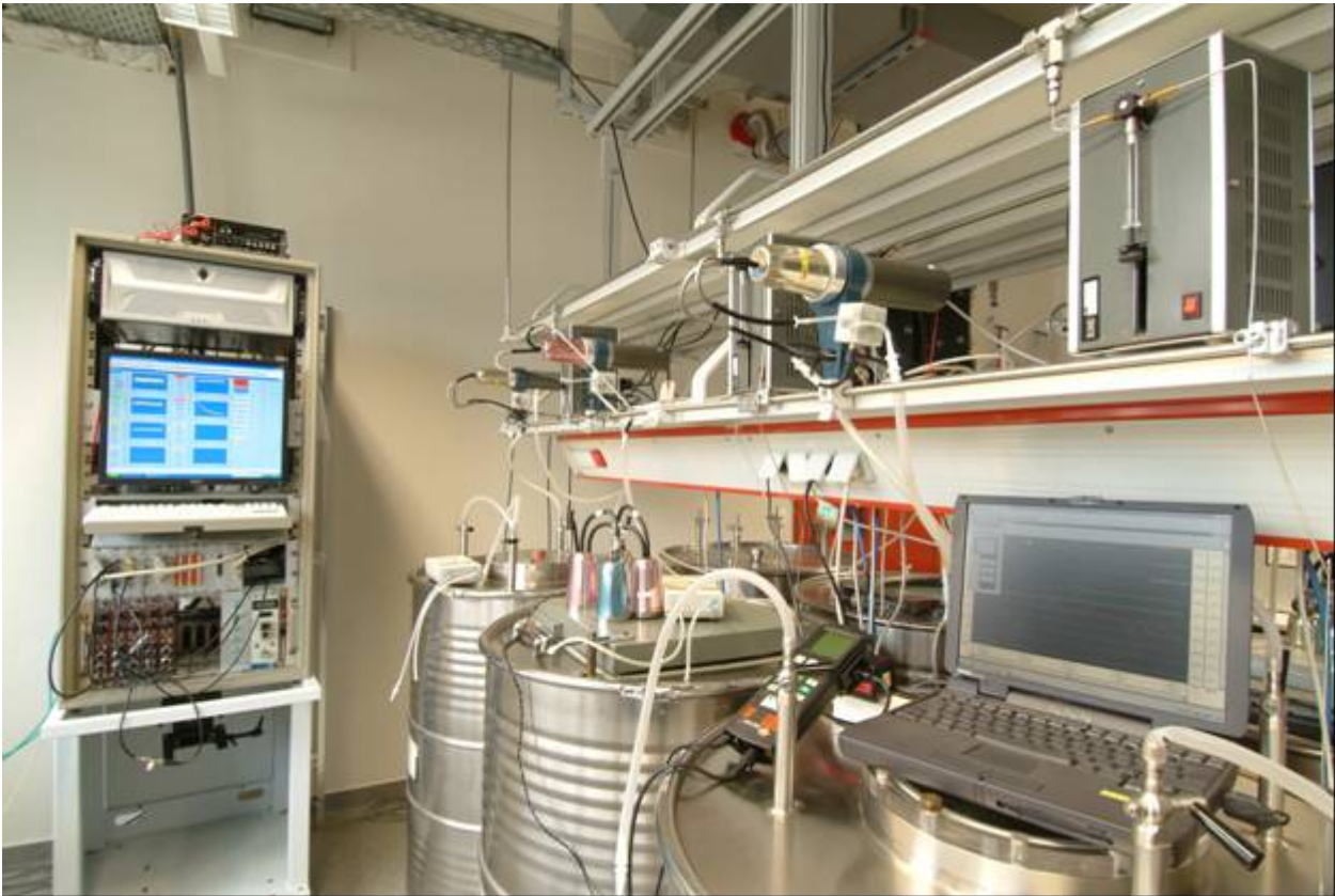
Abbildung 3-1: Kalibrierlaboratorium für Radonmessgeräte des Bundesamtes für Strahlenschutz mit Kalibrierbehältern (Volumen: 0,4 m 3 )/ Radon Calibration Laboratory of the Federal Office for Radiation Protection with calibration containers (volume: 0.4 m 3 )
