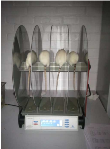
Abb. 7: RotaRod- Apparatur mit 4 Ratten auf der rotierenden Walze.
