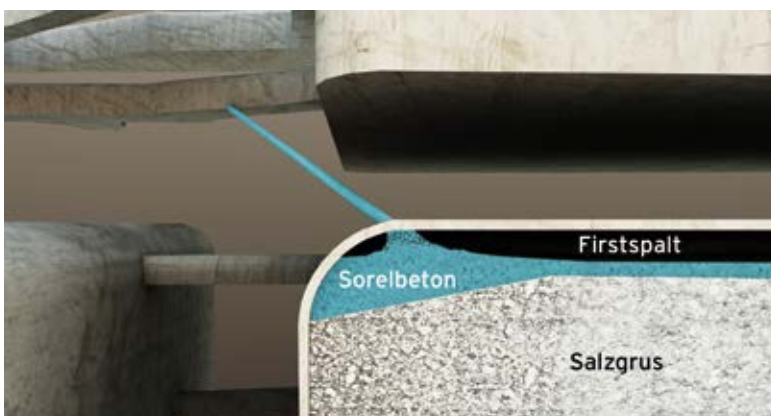
Abb. 12: Darstellung des Prinzips der Firstspaltverfüllung zur Stabilisierung der Südflanke der Schachtanlage Asse II.
