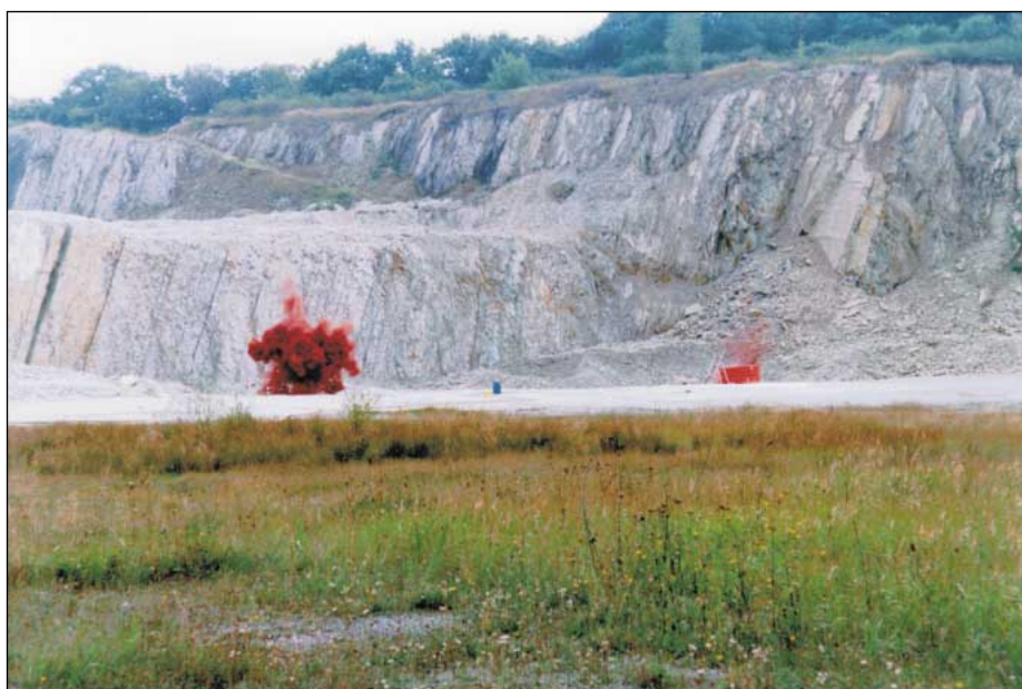
Abbildung KT-5 Vorführung der Rückhaltewirkung durch synchrone Umsetzung von zwei Sprengsätzen
