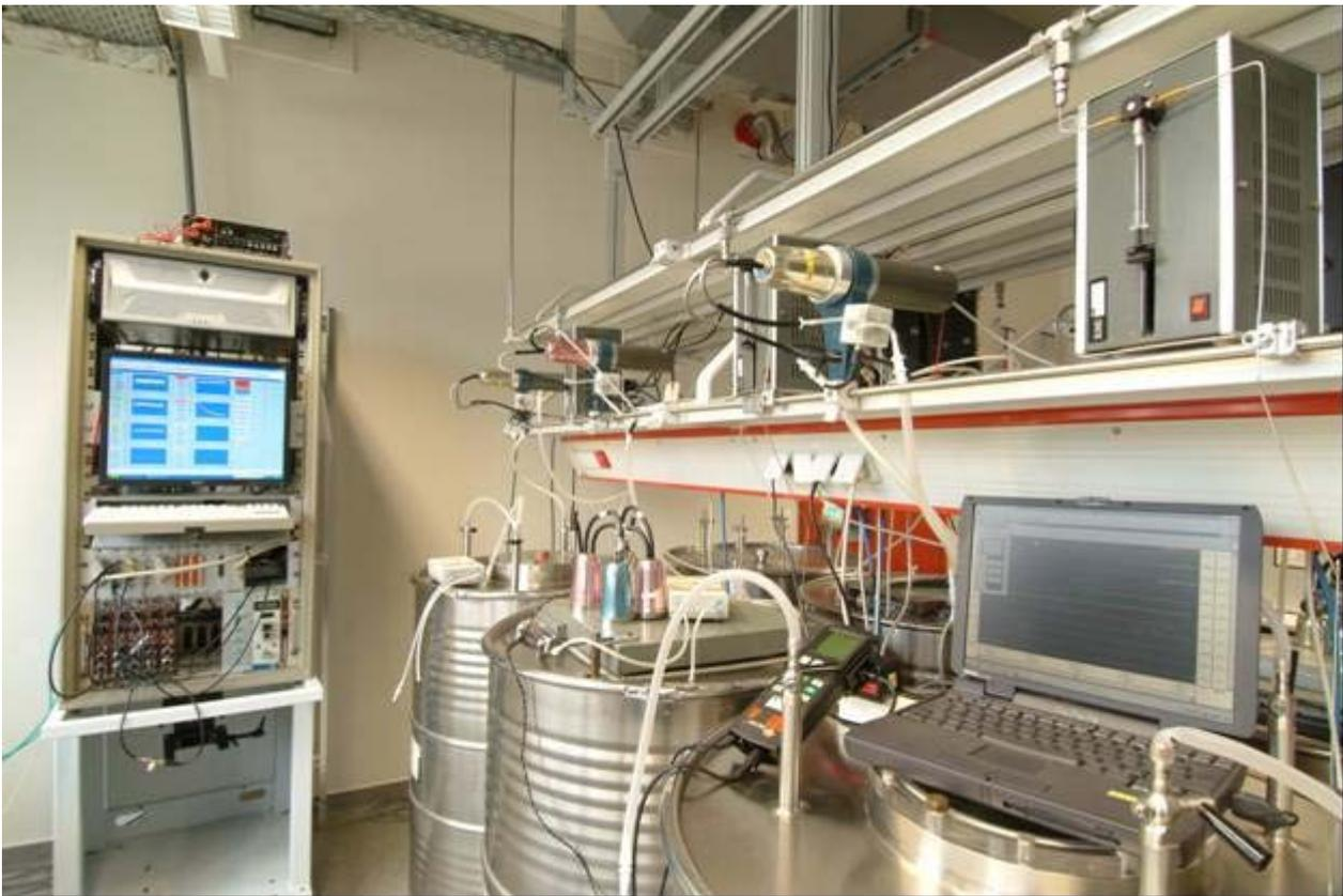
**Abbildung 3-1: Kalibrierlaboratorium für Radonmessgeräte des Bundesamtes für Strahlenschutz mit Kalibrierbehältern (Volumen: 0,4 m<sup>3</sup>)/ Radon Calibration Service Laboratory of the Federal Office for Radiation Protection with calibration containers (volume: 0.4 m<sup>3</sup>)**
