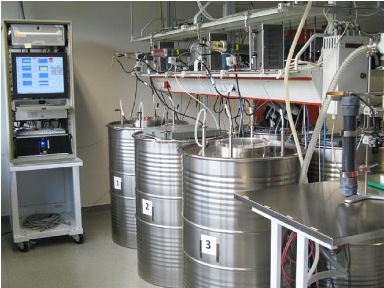
Abbildung 3-1: Kalibrierlaboratorium für Radonmessgeräte des Bundesamtes für Strahlenschutz mit Kalibrierbehältern (Volumen: 0,4 m 3 ) / Figure 3-1: Radon Calibration Laboratory of the Federal Office for Radiation Protection with calibration containers (volume: 0.4 m 3 )
