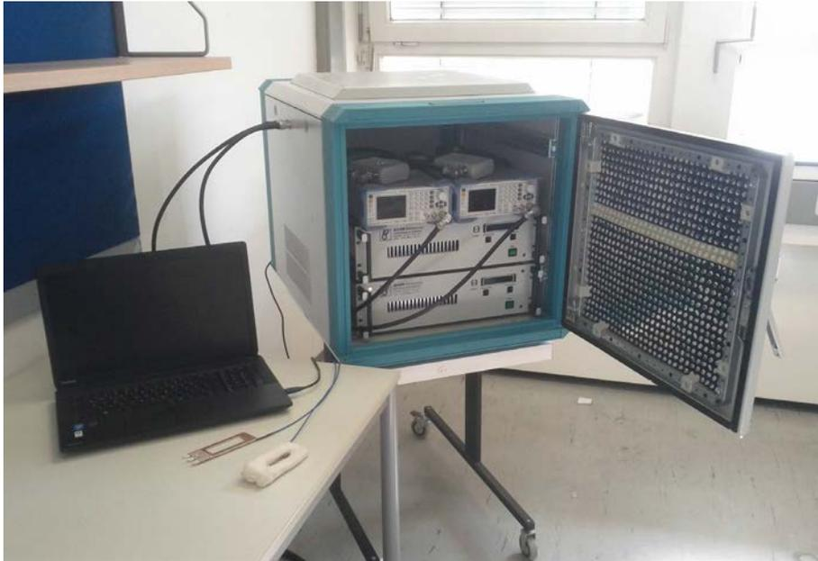
**Abb. VI.2: Foto der assemblierten Expositionsanlage.** Alle Hochfrequenzkomponenten der Signalgenerierung, Signalverstärkung und Leistungsmessung sind in einem versperrbaren 19 Zoll Geräteschrank untergebracht.
