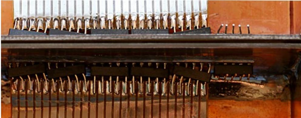
**Abb. V.1: Tiefpaßfilter für EEG-Polysomnographieeingänge des Registriergerätes.**
