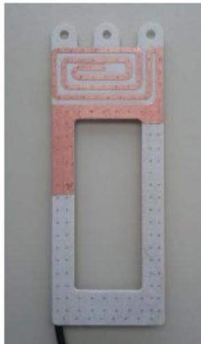
**Abb. VI.3: Vorderseite der entwickelten planaren Dualband-Antenne für TETRA (385 MHz) und GSM900 (915 MHz) zur Befestigung am Probandenkopf.**
