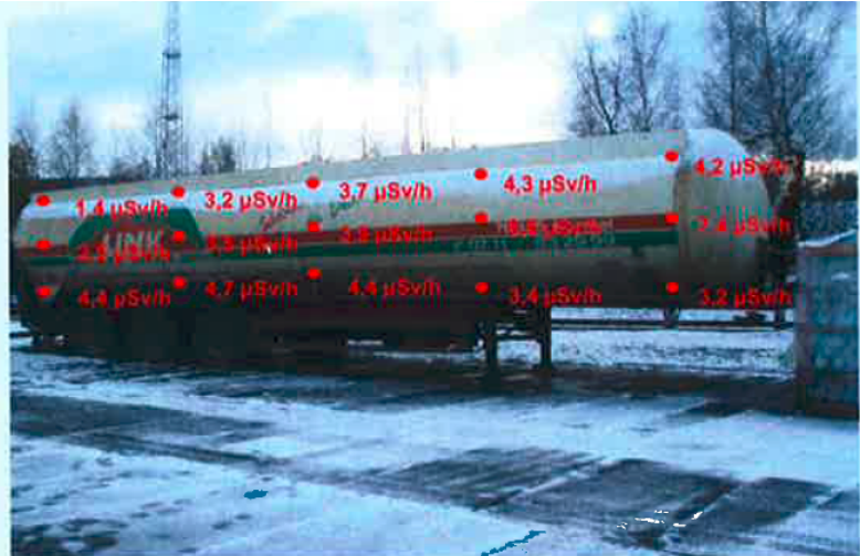
Abbildung 2-6: Provisorisches Zwischenlager für den kontaminierten Staub [FAN 15]
