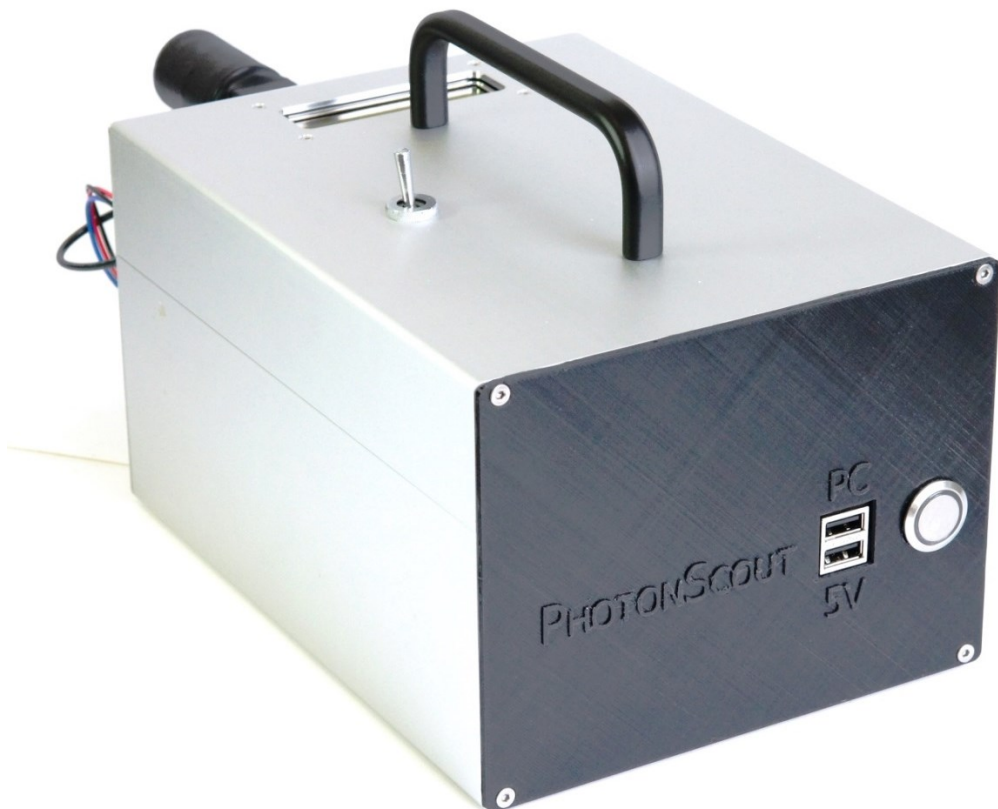
Abbildung 23: Rückansicht mit USB-Schnittstelle, Ladebuchse und Einschaltknopf
