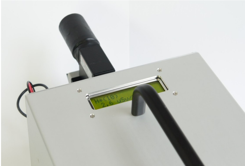
Abbildung 22: Geschlossenes Gerät mit H^*(10) -Sonde und Blick aufs Display.
