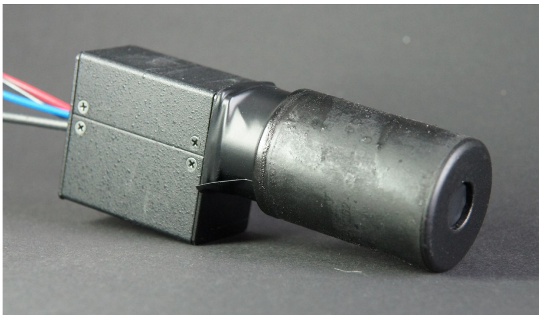
Abbildung 10: Fertiger H^*(10) –Sensor mit seitlicher Bleiabschirmung
