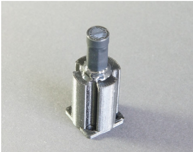
Abbildung 9: Sensorkopf einschließlich der H^*(10) –Kappe lichtdicht versiegelt
