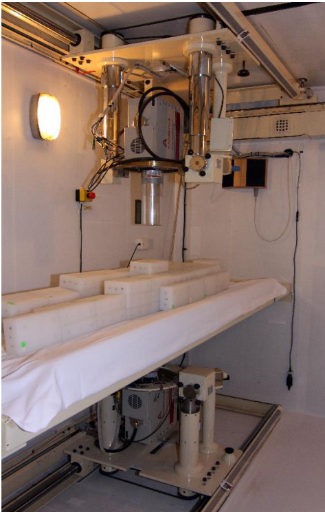
Abbildung 3a: Kalibrierphantom (70-kg-Konfiguration).
