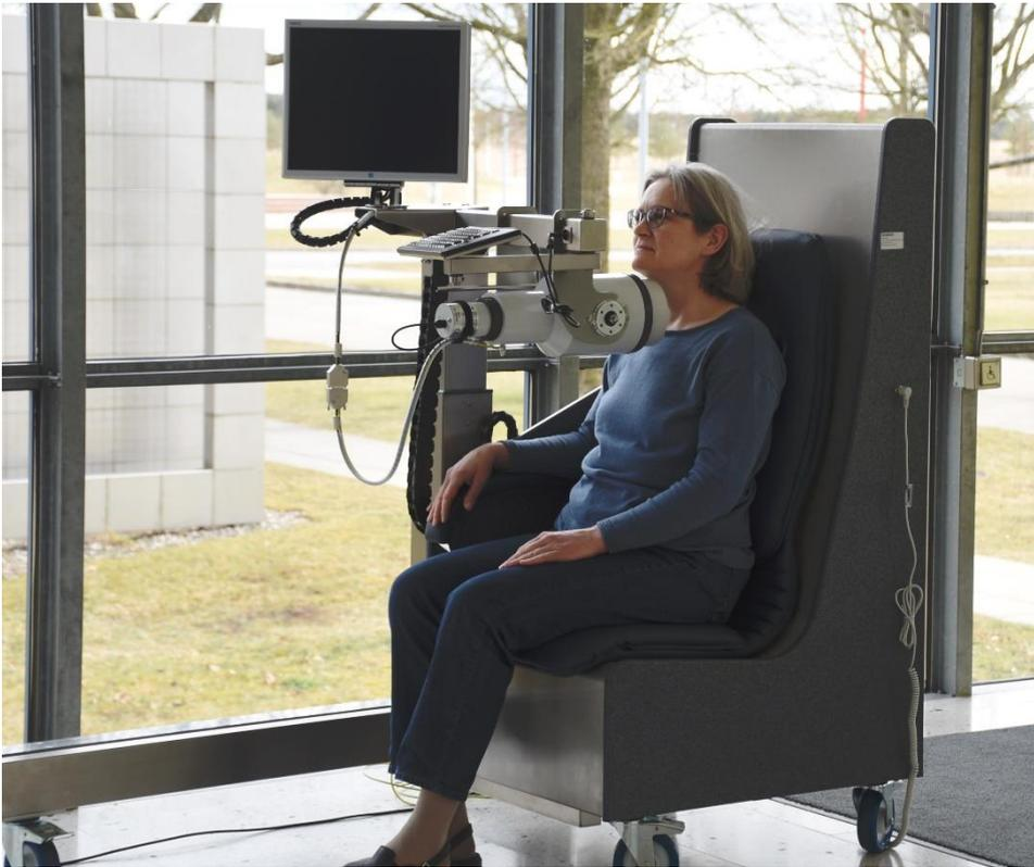
9 Der neue Schilddrüsen-Messplatz mit Szintillationsdetektor, Shadow-Shield-Abschirmung (Ringkollimator und abgeschirmte Rückenlehne) und Auswerte-Computer.
