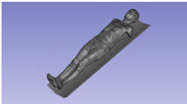
Abbildung 16: Screenshot des männlichen Voxelfantoms des ICRP-Berichtes 110. Die Arme wurden entfernt, da sie bei Untersuchungen am Körperstamm im Normalfall über dem Kopf gelagert werden und somit nicht im Strahlengang liegen. Zusätzlich wurde ein Tisch eingefügt, dessen Dichte gerätespezifisch angepasst wurde.
