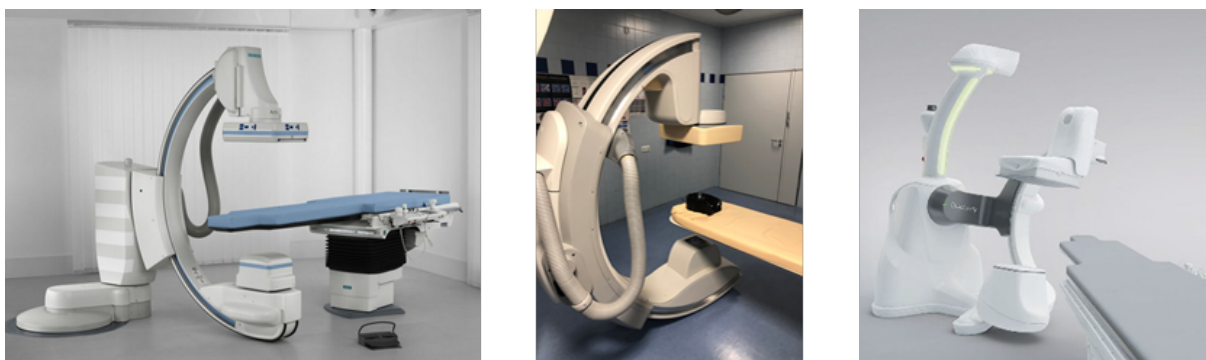
Abbildung 5: Drei exemplarische Beispiele für Angiographiesysteme mit CBCT-Funktion. Links: Siemens Artis Zee mit Bodenmontage (Foto: Siemens Healthineers). Mitte: Philips Allura Xper FD20 mit Deckenmontage. Rechts: General Electric Discovery IGS 74 (Foto: General Electric)
