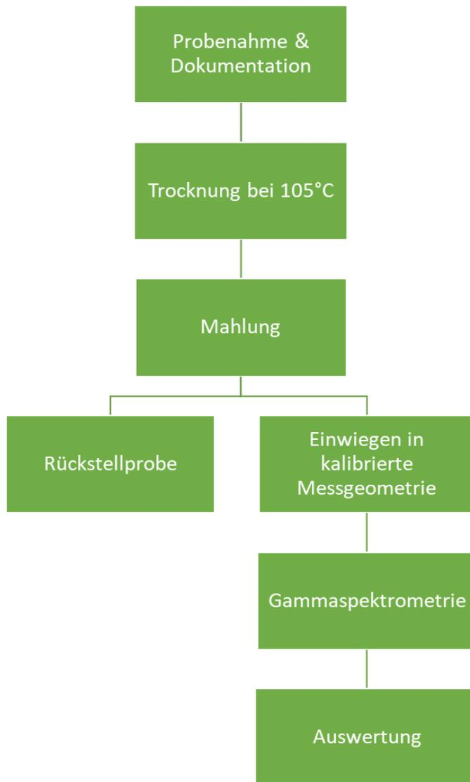
5 Schematische Darstellung der Probenvorbereitung, Messung und Auswertung.
