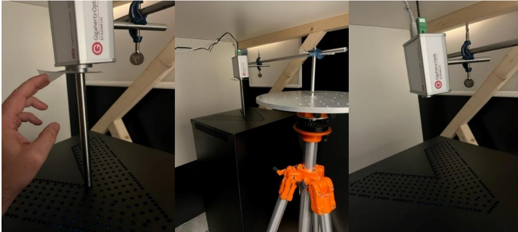
Abbildung 3 Beispielhafte Abstand-Justage des BTS2048-UV mit Abstandsnormal am Gerät Nr. 26.
