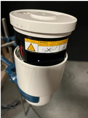
Abbildung 7 Die Abdeckung bei Gerät Nr. 02 lässt sich sehr leicht durch einen Bajonettverschluss abheben. Danach kann auch der Filter ohne Hindernis herausgezogen werden und es kann direkt in die UV Quelle geblickt werden. Dies ist möglich, da die Strahlungsquelle keinen Mechanismus besitzt der sie bei geöffnetem Gerät deaktiviert. Aufkleber und Hinweise warnen jedoch kaum zu übersehen davor.
