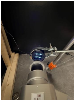
Abbildung 9 Bei Gerätenummer 09 kann mittels Drehverschluss die Kappe zu den LEDs leicht geöffnet werden, zwecks Filterwechsel. Allerdings haben die LEDs keinen Sicherheitsmechanismus und können somit auch bei herausgenommen Filter betrieben werden.
