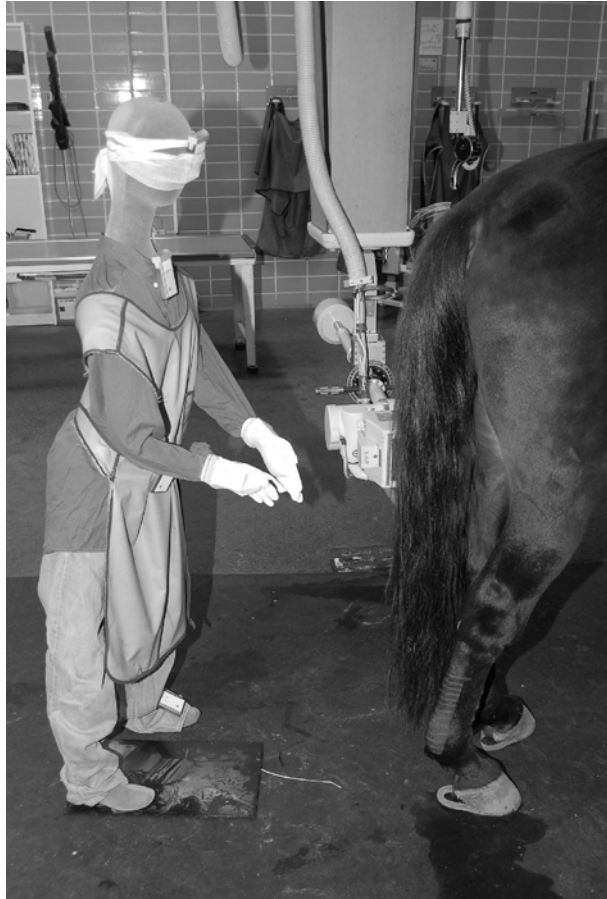
Abbildung 2: Beispiel einer Messung am Tierphantom (Tarsalgelenk, latero-medial 90°, Messposition: Stirn, Schilddrüse, Brust, Gonaden, Fuss)
