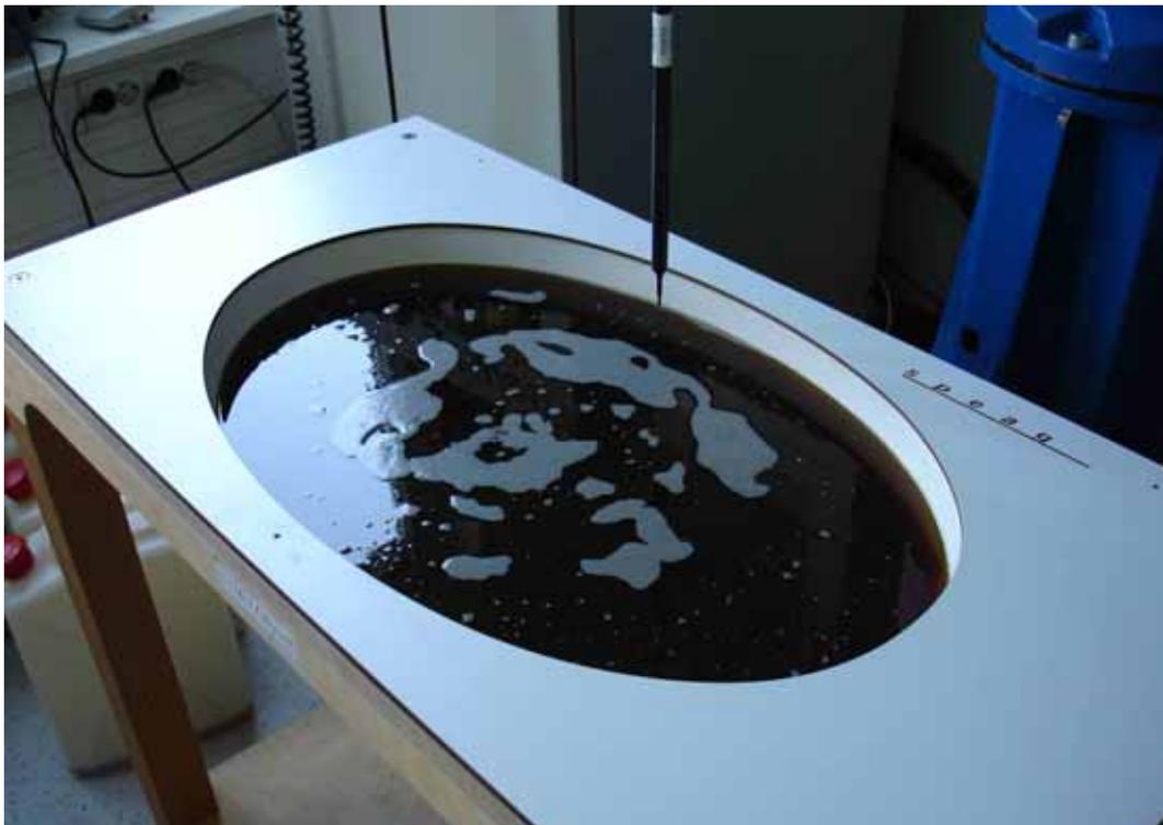
Bild 6.16: Flachphantom und DASY4 für SAR-Messungen am Endgerät
