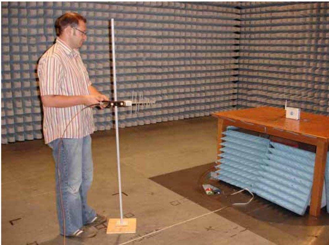
Bild 6.2: Messaufbau bei der Expositionsmessung unter Laborbedingungen
