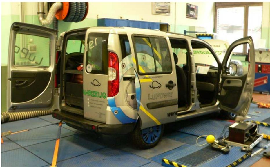
Abbildung 7.49: Doblo Electric auf dem Leistungsprüfstand
