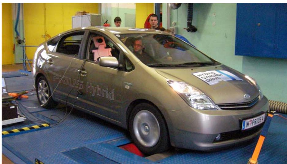
Abbildung 7.15: Der Toyota Prius auf dem Leistungsprüfstand
