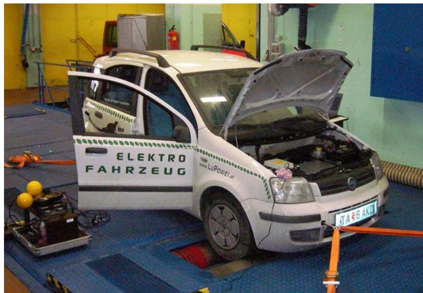
Abbildung 7.40: Panda Electric auf dem Leistungsprüfstand
