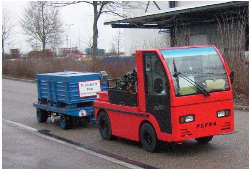
Abbildung 7.83: Untersuchter Elektroschlepper 780 mit ca. 9 t Schleplast während der Messfahrten
