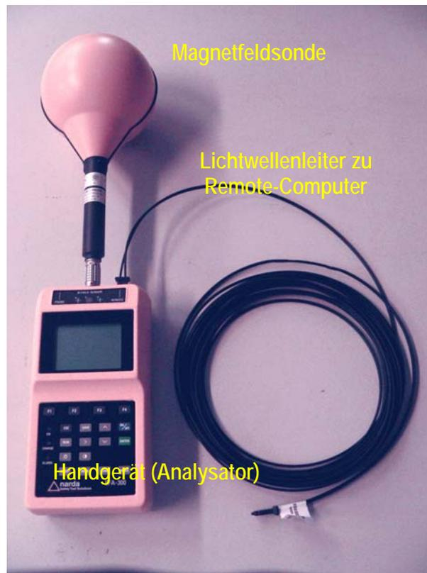
Abbildung 4.4: Das Mess-System EFA 300 (Narda Safety and Test Solutions)
