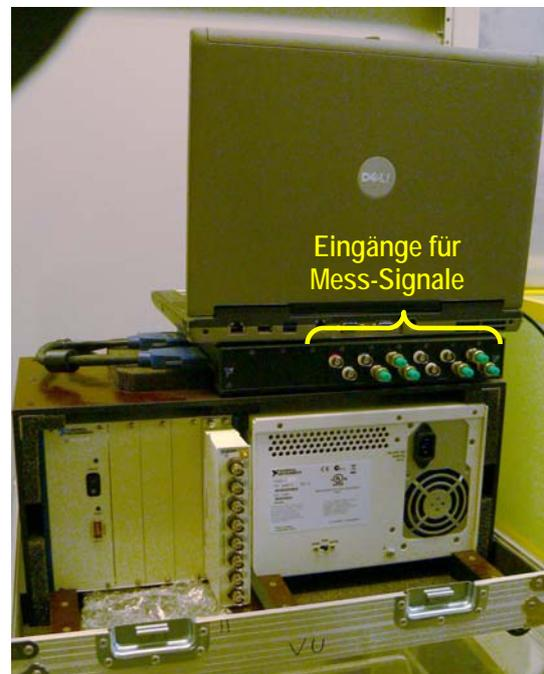
Abbildung 4.1: Vorder- und Rückansicht des Inhouse entwickelten Mess-Systems ARC-NIFSPEC (Austrian Research Centers)
