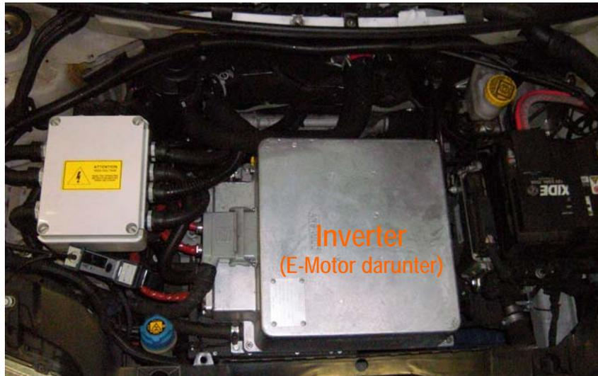
Abbildung 7.39: Motorraum des Panda Electric
