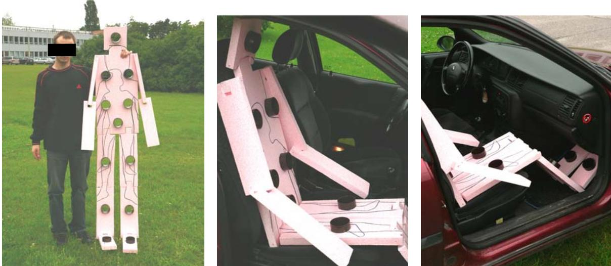
Abbildung 6.1: Aus Hartschaumstoff gefertigtes Körpermodell zur Festlegung der Messpunkte (links: stehend, Mitte und rechts: am Beifahrersitz eines PKWs)
