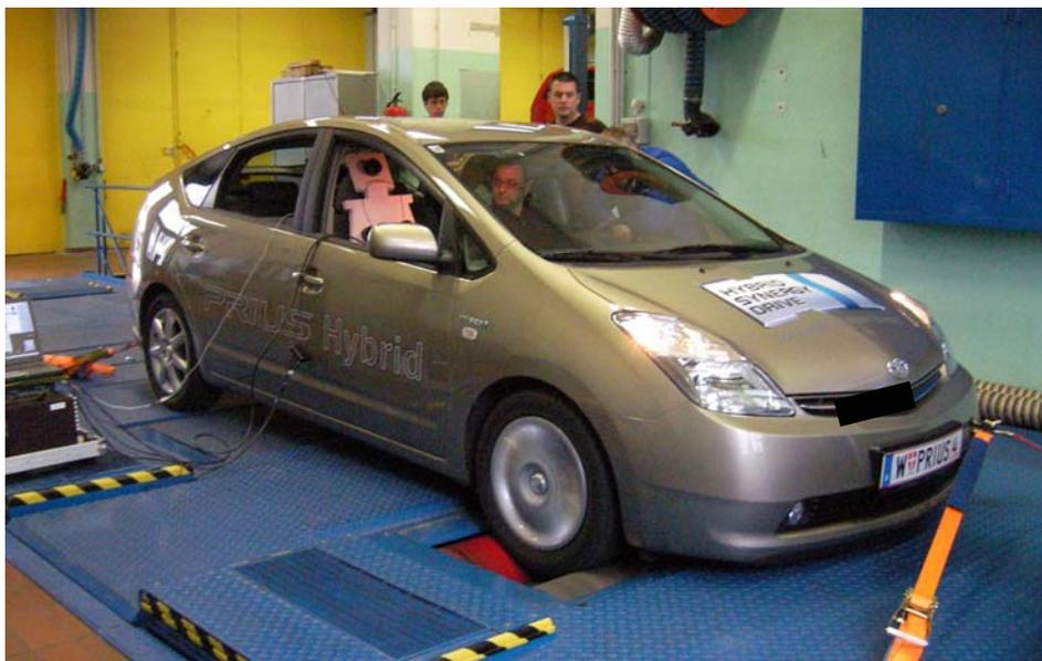
Abbildung 6.5: Toyota Prius auf dem Leistungsprüfstand
