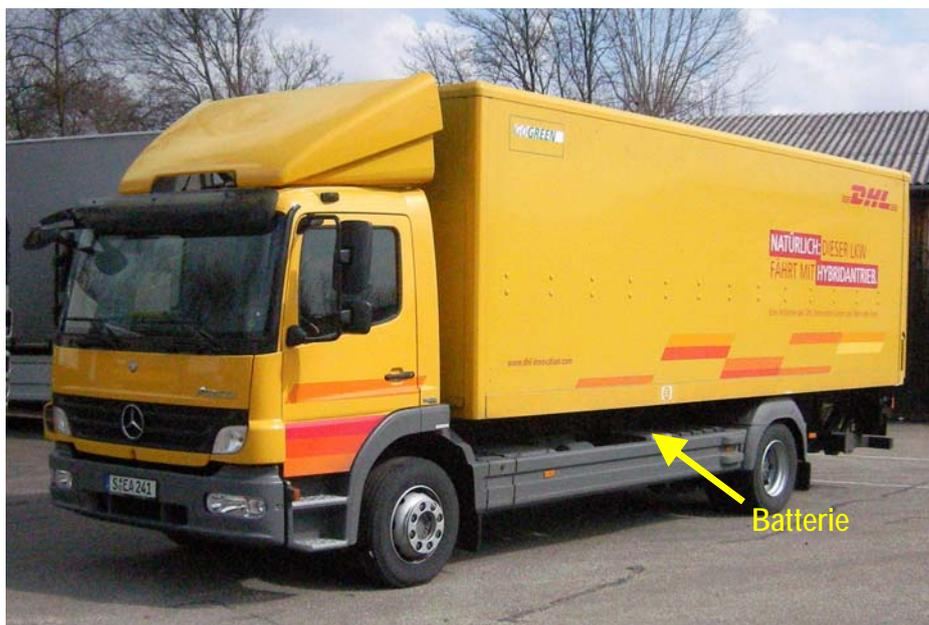
Abbildung 7.73: Das untersuchte Fahrzeug, der Atego Blue TEC Hybrid
