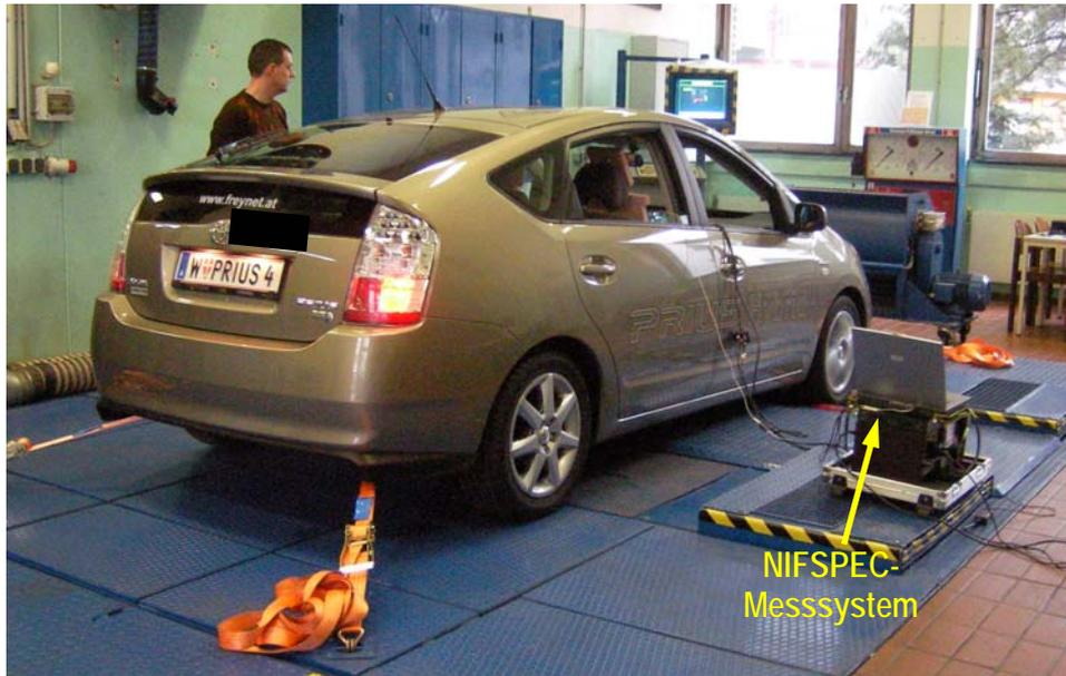
Abbildung 6.6: Toyota Prius auf dem Leistungsprüfstand
