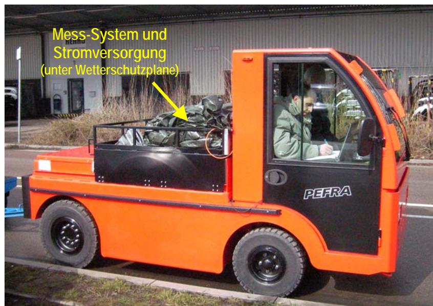
Abbildung 7.82: Untersuchter Elektroschlepper 780 von Fa. PEFRA. Das NIFSPEC Mess-System (inkl. autarker Stromversorgung) befindet sich auf der Ladefläche direkt hinter der Fahrerkabine (unter Regenschutzplane)
