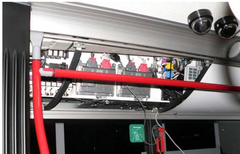
Abbildung 7.59: Hybridelektronik oberhalb des untersuchten Sitzplatzes A, bei abgenommener Abdeckung (vgl. Abbildung 7.58 )
