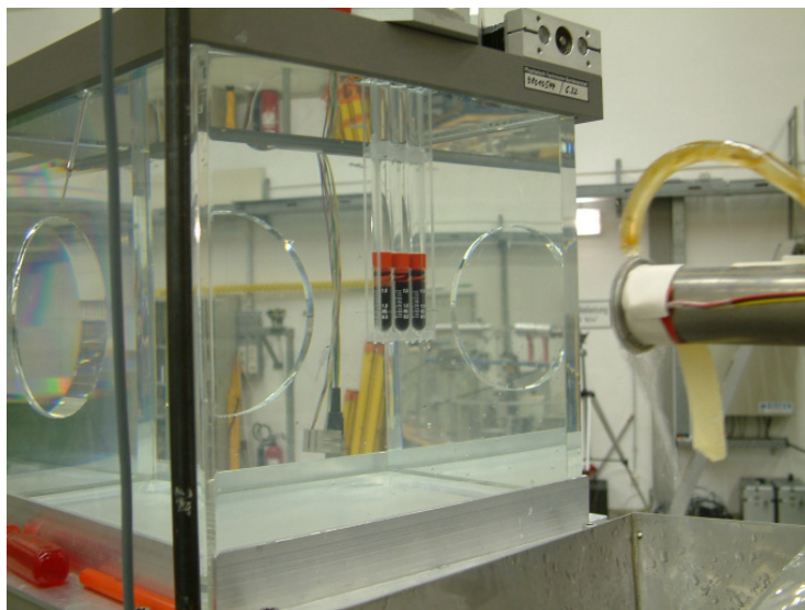
Abbildung 10: Blutproben im Wasserphantom.
