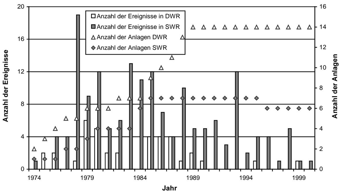
Abbildung 18-2 Gemeldete Ereignisse über Rohrleitungsschäden des Wasser-Dampfkreislaufes
