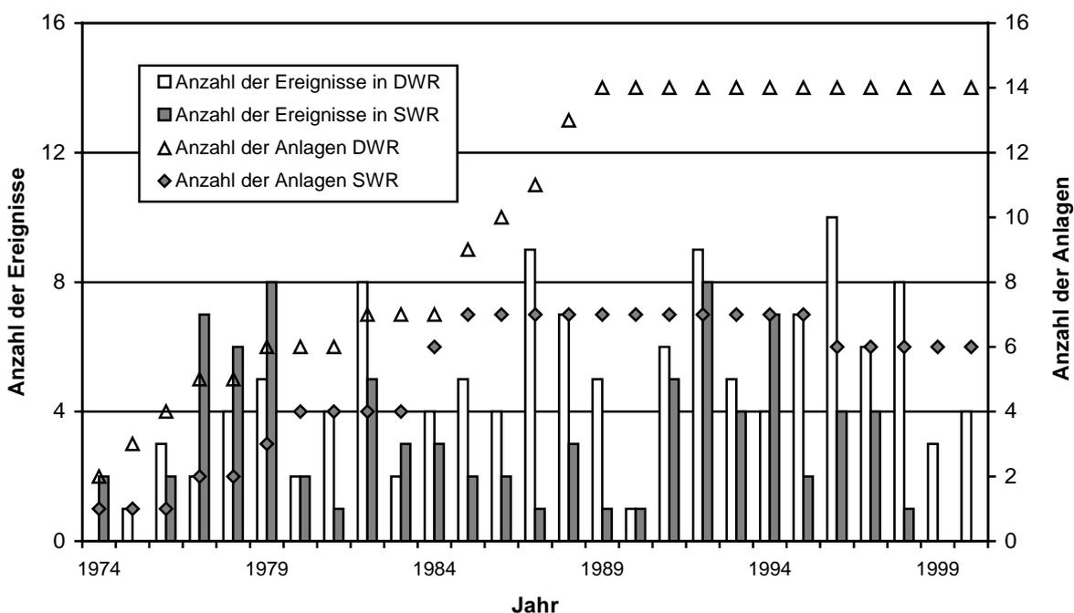
Abbildung 18-1 Gemeldete Ereignisse über Rohrleitungsschäden des Reaktorkühlkreislaufts und der nuklearen Hilfssysteme
