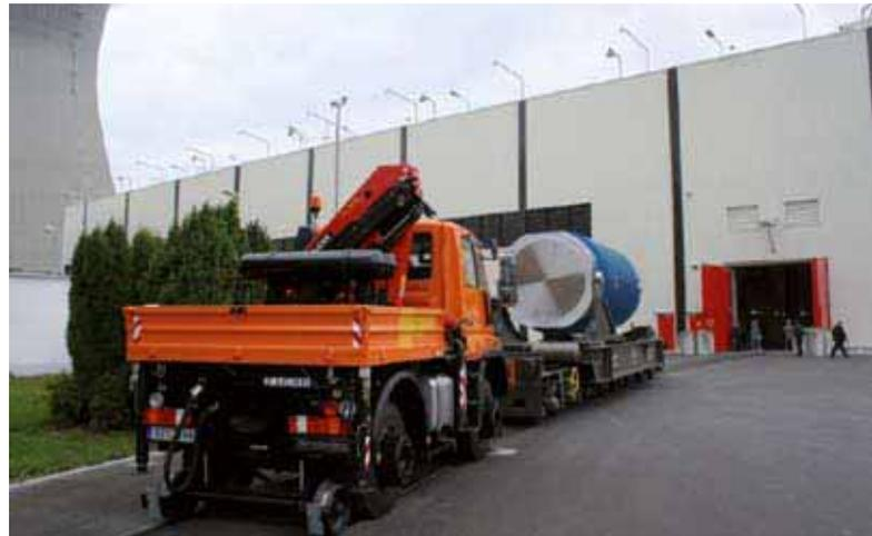
Transport des Behälters auf dem Betriebsgelände zum Standort-Zwischenlager
