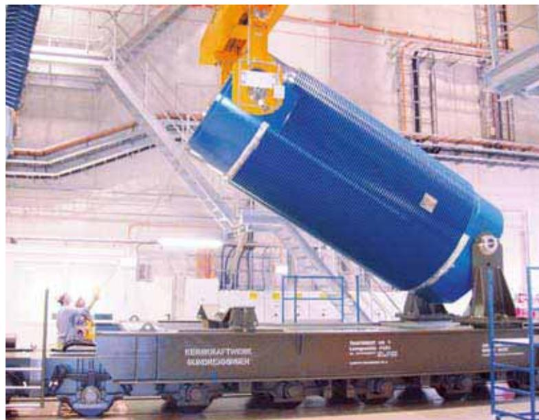
Aufnahme des Behälters mit dem Hallenkran im Eingangsbereich
