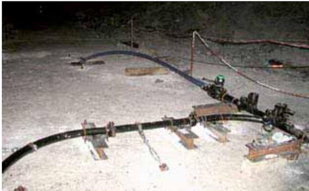
**Salzbetonförderanlage – Leitung unter Tage; Einlauf in Verfüllbohrung unter Tage**
