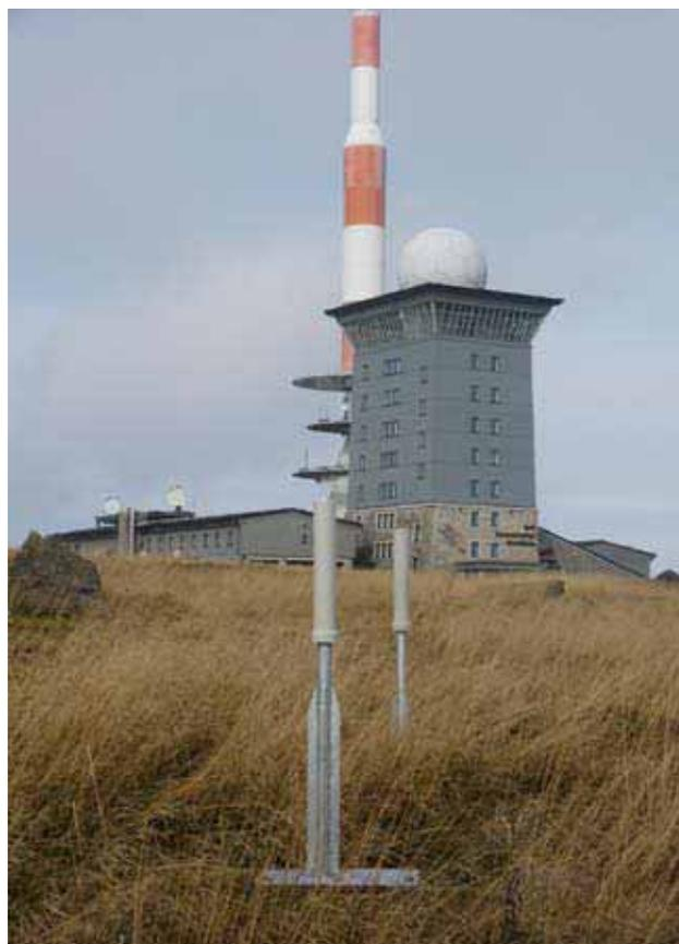
**Spektroskopische Sonde (im Vordergrund) und klassische ODL-Sonde im Parallelbetrieb auf dem Brocken**
