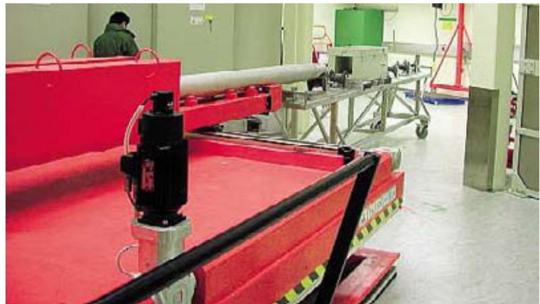
Umladen eines ESBB-Behälters (Einzel-SNR-Brennelement-Behälter) vom Scherenhubwagen auf einen Transportwagen für den innerbetrieblichen Weitertransport zur Verpackungsstation
