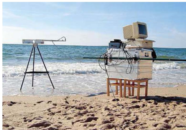
Messaufbau mit schwenkbarem Detektor (links) und thermostabilisiertem Spektralradiometer (rechts) am Sylter Strand
