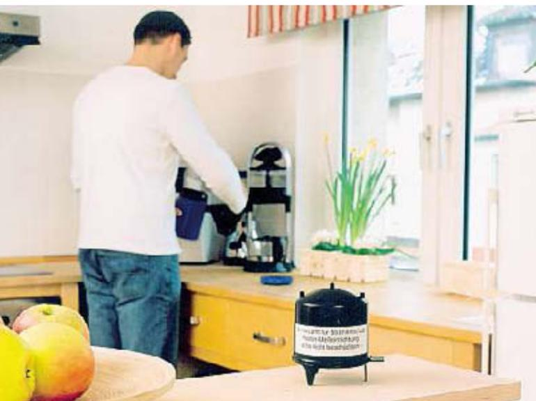
Mit so genannten passiven Messgeräten kann die Radonexposition in Häusern und an Arbeitsplätzen auf einfache Weise ermittelt werden.
