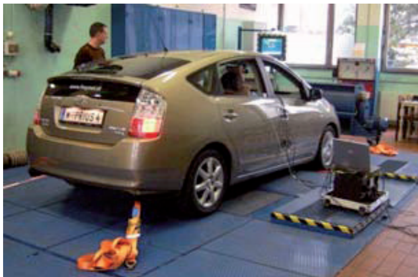
Abbildung 1: Immissionsmessungen am Leistungsprüfstand mit dem Toyota Prius
