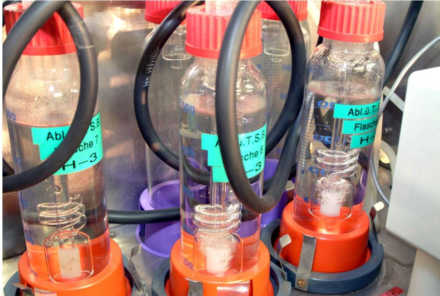
Abbildung 17: Waschflaschen des Tritium(H-3)-Probenahmeverfahrens
