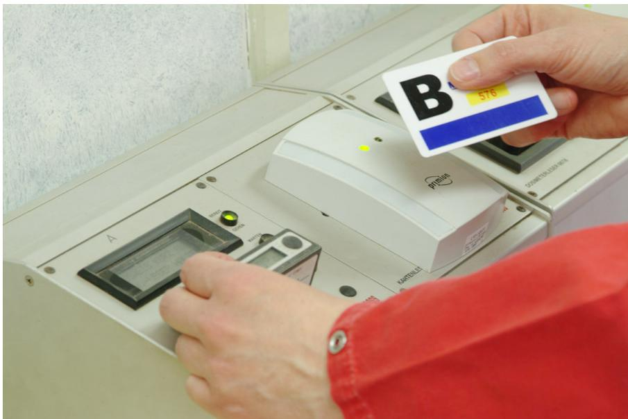
**Abbildung 10: Auslesen betrieblicher Dosimeter im Kontrollbereich des ERAM**
