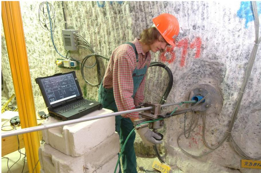
**Abbildung 6: Durchführung einer Lageänderungsmessung**
