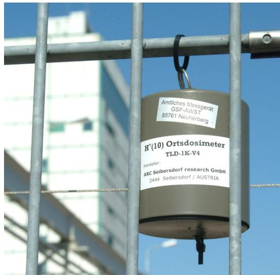
Abbildung 24: Festkörperdosimeter
