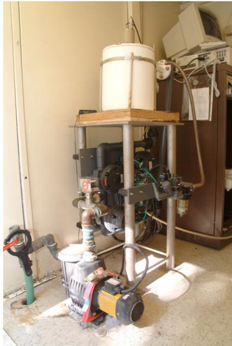
**Abbildung 27: Wasserprobenahmegerät zur Probenahme aus dem Salzbach**
