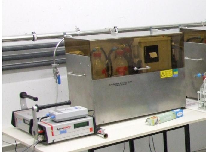
Abbildung 19: Sammeleinrichtung zur Bestimmung des Radionuklids Kohlenstoff-14
