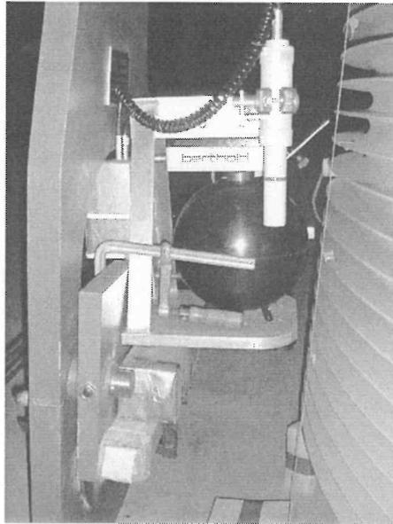
Bild 3: Anordnung der Messgeräte für bestimmte Dosisleistungsmessungen
