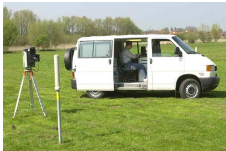
Mobiles Messsystem des BfS für In-situ-Gammaspektrometrie
