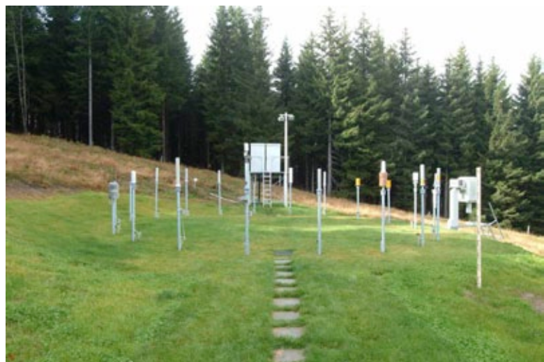
Interkalibrationsplattform an der Messstation Schauinsland: Die Messwerte und Zeitreihen unterschiedlichster ODL-Sonden aus verschiedenen Messnetzen europäischer Länder werden hier verglichen.
