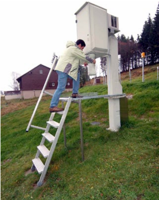
Nuklidspezifischer In-situ-Detektor zur Erfassung der Bodenkontamination an der Station Schauinsland
