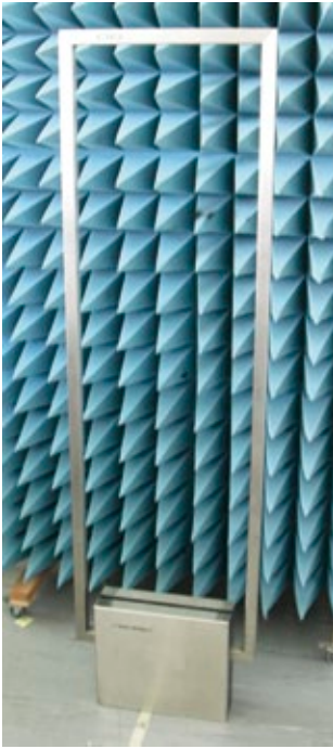
Laboraufbau der Sende-Empfangsvorrichtung eines Zutrittskontrollsystems (links) und entsprechendes Computermodell zusammen mit einem dreidimensionalen anatomischen Körpermodell für eine rechnergestützte dosimetrische Simulationsrechnung (rechts)
