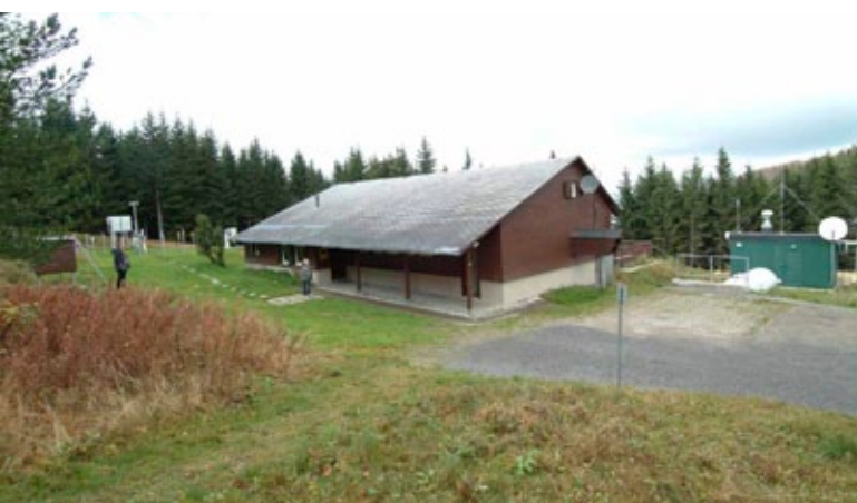
Die Messstation Schauinsland mit Interkalibrationsplattform (links hinten) und das Spurenmesssystem RASA für die Überwachung des Kernwaffenteststoppabkommens (grüner Container rechts)
