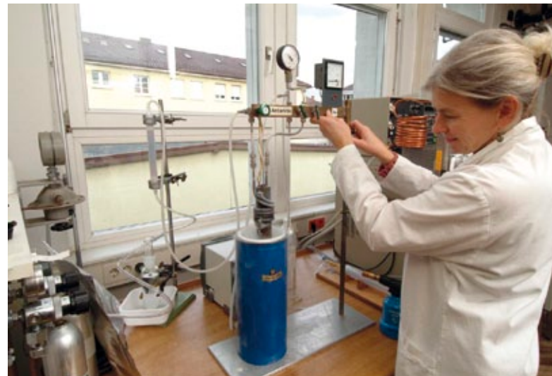
Aufbereitung und Analyse einer Luftprobe aus der Antarktis im Edelgaslabor
