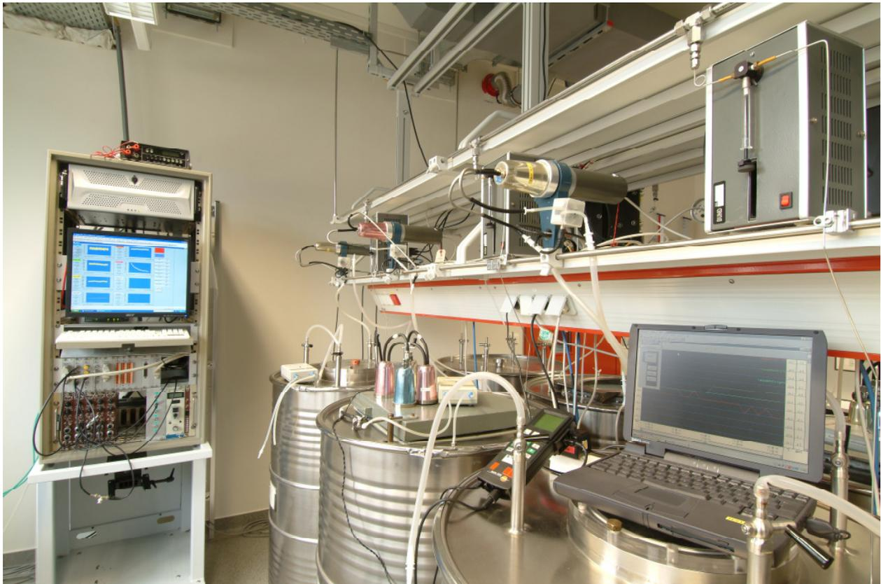
**Abbildung 1: Kalibrierlabor für Radonmessgeräte des Bundesamtes für Strahlenschutz mit Kalibrierbehältern (Volumen: 0,4 m<sup>3</sup>)**
