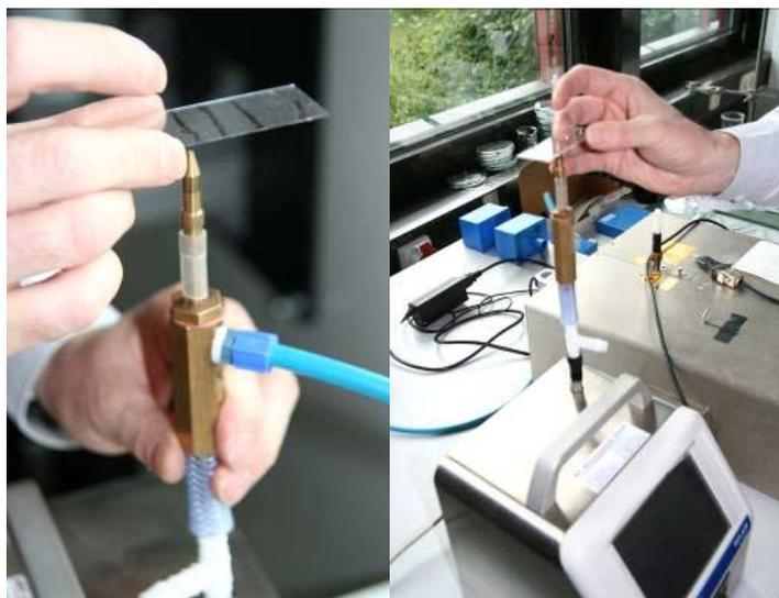
**Abb. 4.10:** Absaugung der Partikel von der Glasoberfläche (drei Streifen) und Zuführung zum Partikelzählgerät: Die Absaugung erfolgt mit einer Venturidüse. Über den blauen Schlauch wird Druckluft zugeführt, die nach dem Venturiprinzip in der Absaugspitze einen Unterdruck erzeugt, der die Partikel von der Glasoberfläche ablöst.
