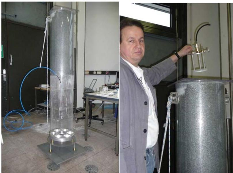
**Abb. 4.3:** Sedimentationsrohr und Druckluftdüse zur Verneblung von festen Pulvern.
