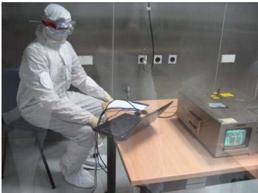
**Abb. 4.31:** Reinraumkammer mit Partikelzähler und Proband im Reinraumanzug. Das Photo wurde von außen durch ein Fenster im Reinraum aufgenommen.
