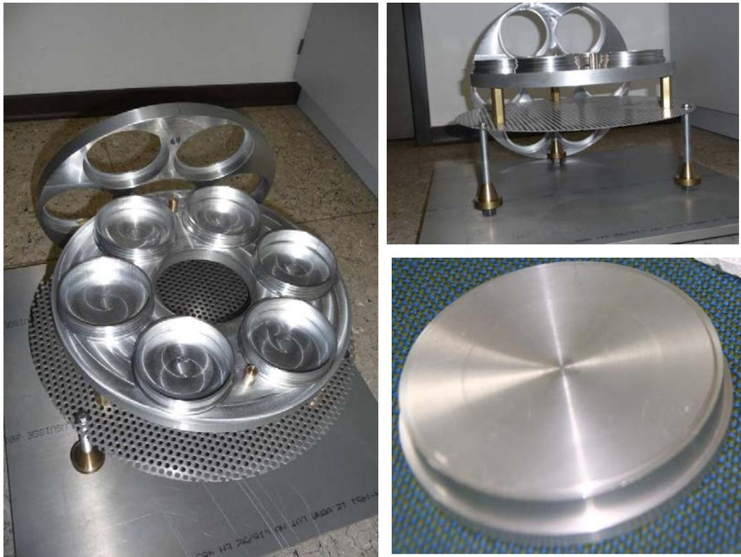
**Abb. 4.4:** Probenträger für 6 Aufnahmen der Testoberflächen. Rechts unten: Aluminiumscheibe für das zentrale Segment des Probenträgers.
