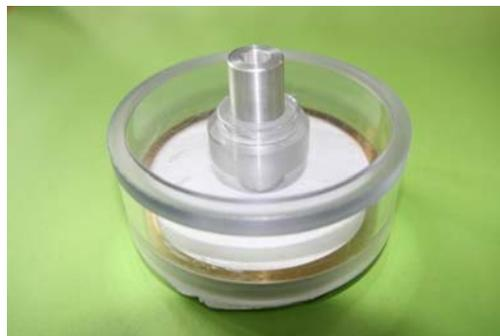
**Abb. 4.16:** Spanvorrichtung für die Stoffprobe. Durch die Wahl des Gewichts im Zentrum kann die Spannung im Stoff eingestellt werden.
