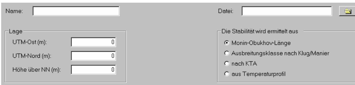
**Abbildung 3-13:** Hinzufügen einer eigenen Stationsdatei: Angaben zur Lage, zum Namen und zur Datei in der die Daten gespeichert werden sollen, Festlegung der Standardmethode zur Bestimmung der Stabilität.
