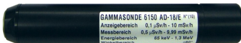
Abb. 16: Diese Gamma-Messsonden der Firma Automess (Typ 6150AD-18/E) sind in der nuklearmedizinischen Therapiestation in Würzburg zur Patientenüberwachung in die Decke über den Patientenbetten montiert.
