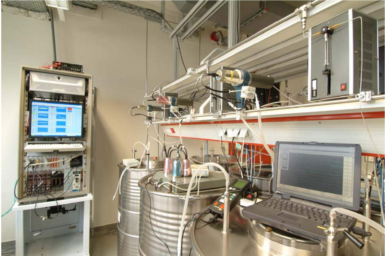
Abbildung 1: Kalibrierlaboratorium für Radonmessgeräte des Bundesamtes für Strahlenschutz mit Kalibrierbehältern (Volumen: 0,4 m 3 ) Figure 1: Radon Calibration Laboratory of the Federal Office for Radiation Protection with calibration containers (volume: 0.4 m 3 )
