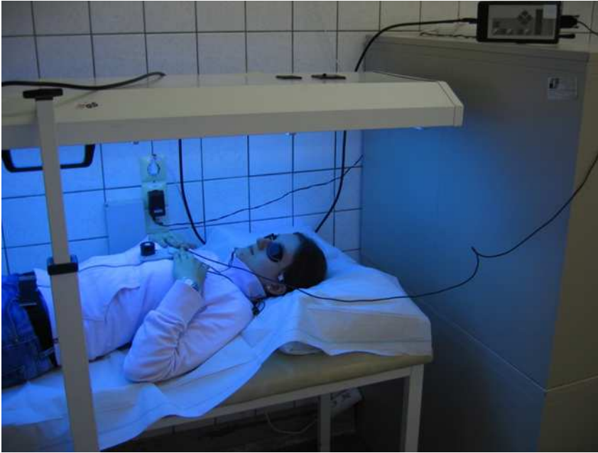
Abb. 7 Durchführung der UV-Bestrahlung von Gesicht und Händen mit Messung der applizierten, erythem-effektiven Bestrahlung H_{er} mit Breitbandradiometer P 9710 mit Erythemsensor
