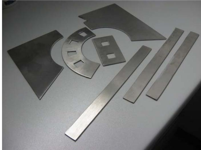
**Abbildung 48:** Exemplarische Zusammenstellung unterschiedlicher Blenden zur Unterdrückung von Überstrahlungsartefakten
