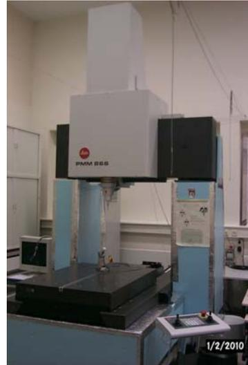
**Abbildung 36:** Abbildungen des Fokusvariationsmessgerätes Alicona Infinite Focus (links) sowie des taktilen Koordinatenmessgerätes Leitz PMM 866 (rechts)
