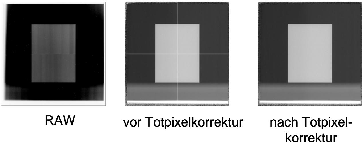
**Abbildung 46:** Schematische Darstellung der Änderung der Bilddaten durch die einzelnen Schritte der Bildaufbereitung; links: Original, Mitte: nach der Homogenitätskorrektur, rechts: nach der Korrektur defekter Bildpunkte
