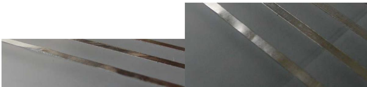
**Abbildung 73:** Detail der Aluminiumstreifen aus einem DSA-Prüfkörper; die relevante Verbiegung des vorderen Streifens ist gut zu erkennen
