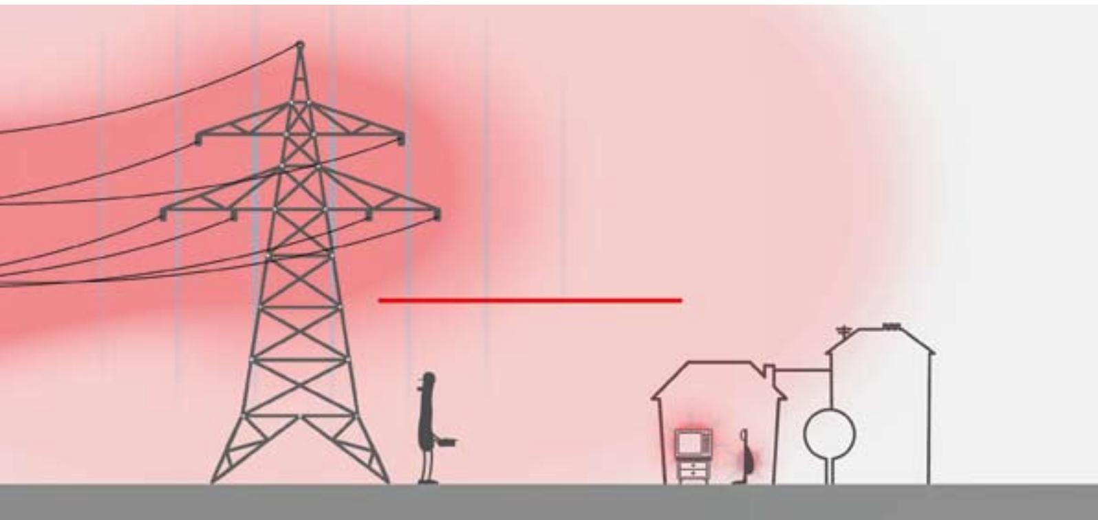
Unterhalb der Grenzwerte sind unvermeidbare Expositionen aus Gründen der Vorsorge nach dem Stand der Technik zu minimieren. Das kann zum Beispiel durch geeignete Abstände erreicht werden. Eine andere technische Maßnahme besteht darin, die Einzelleiter so anzuordnen, dass sich die Magnetfelder größtenteils kompensieren.
