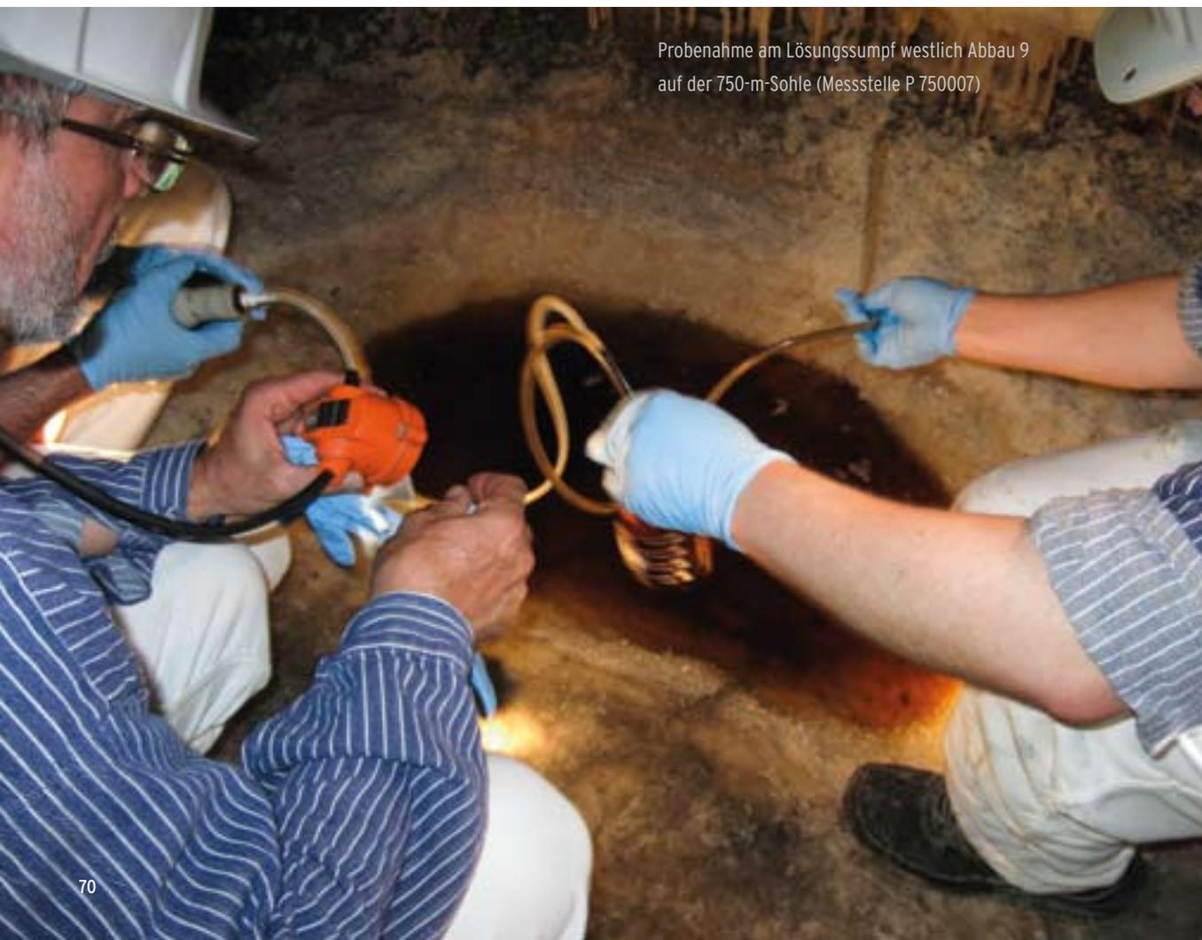
Probenahme am Lösungssumpf westlich Abbau 9 auf der 750-m-Sohle (Messstelle P 750007)
