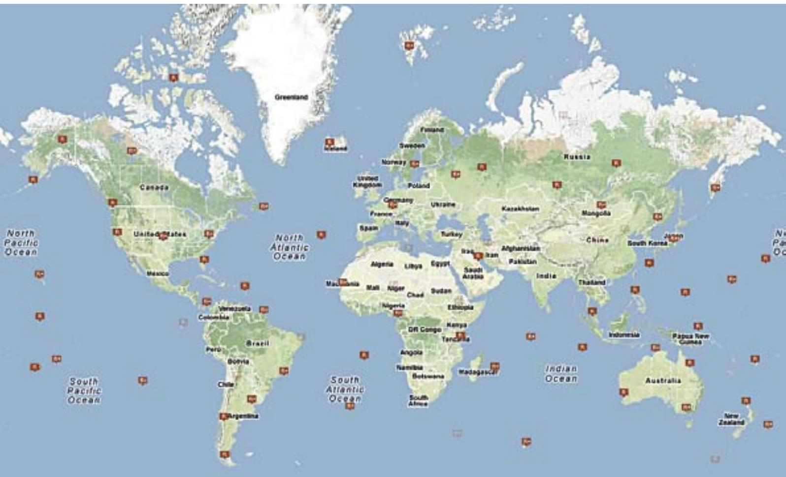
Das weltweite Messnetz der Radionuklidmessstationen der Comprehensive Nuclear-Test-Ban Treaty Organization (CTBTO, [www.ctbto.org](http://www.ctbto.org)). Mit „R“ gekennzeichnete Stationen verfügen über Systeme zur Bestimmung von an Luftstaub gebundener Radioaktivität (wie z. B. Cäsium-137). Stationen, die mit „R+“ gekennzeichnet sind, verfügen zusätzlich über ein Edelgas-Messsystem zur Bestimmung radioaktiver Xenon-Isotope (Quelle: CTBTO).
