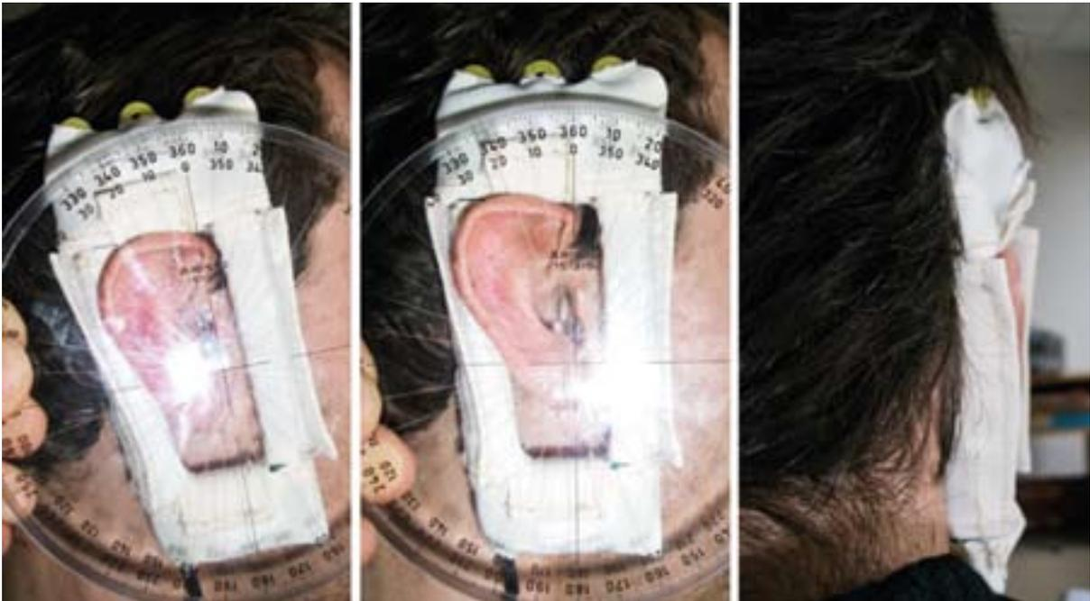
Am Ohr getragene Antenne zur Exposition mit genauer Positionierung
