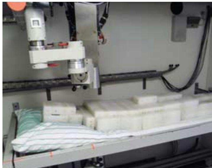
Messung des Ziegelphantoms „Olga“ in einem Ganzkörperzähler
