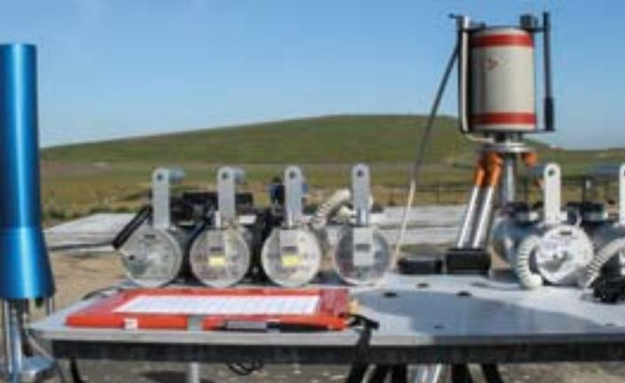
Tragbare ODL-Messgeräte und ein Gammaspекtrometrie-Detektorsystem beim BfS-Kalibriervergleich auf den Referenzmessflächen der Wismut GmbH in Reust (Thüringen)
