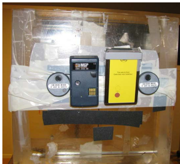
Abbildung 9: Befestigung der EPD auf dem ISO slab-Phantom bei den Messungen unter klinischen Bedingungen. Zwei EPD sind mittig montiert, zwei Referenzdosimeter außen (aus [9])
