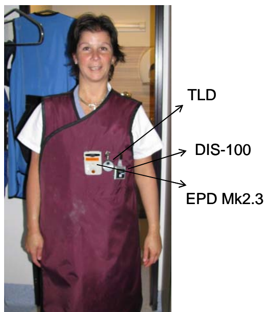
Abbildung 14: Exemplarische Darstellung der Trageweise der EPD sowie der Referenzdosimeter bei der Untersuchung des Ansprechvermögens bei klinischer Tätigkeit
