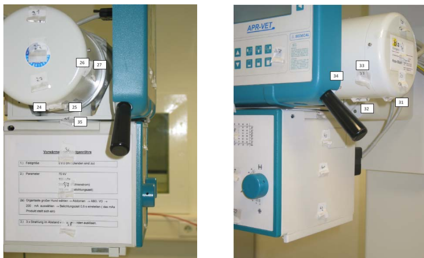
Abbildung 38: Exemplarische Abbildung der Orte an der Oberfläche eines Röntgenstrahlers, an denen eine Messung der Gehäusedurchlassstrahlung erfolgte
