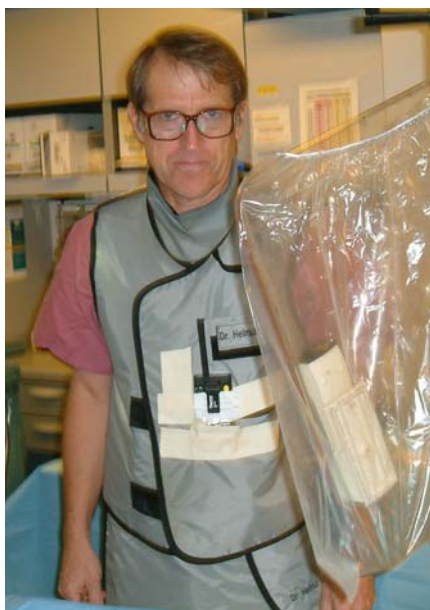
Abbildung 42: Photo einer strahlenexponierten Person mit an der Außenseite der Strahlenschutzkleidung befestigten Dosimetern
