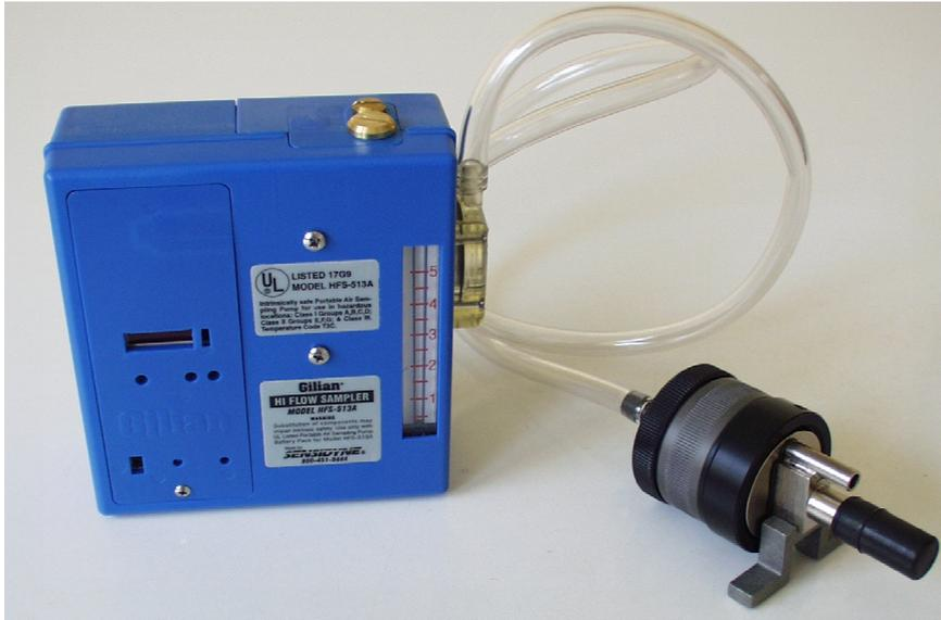
Abbildung C-1: Personengetragenes Probeentnahmesystem der BIA zur Entnahme einer Staubprobe aus der Luft
